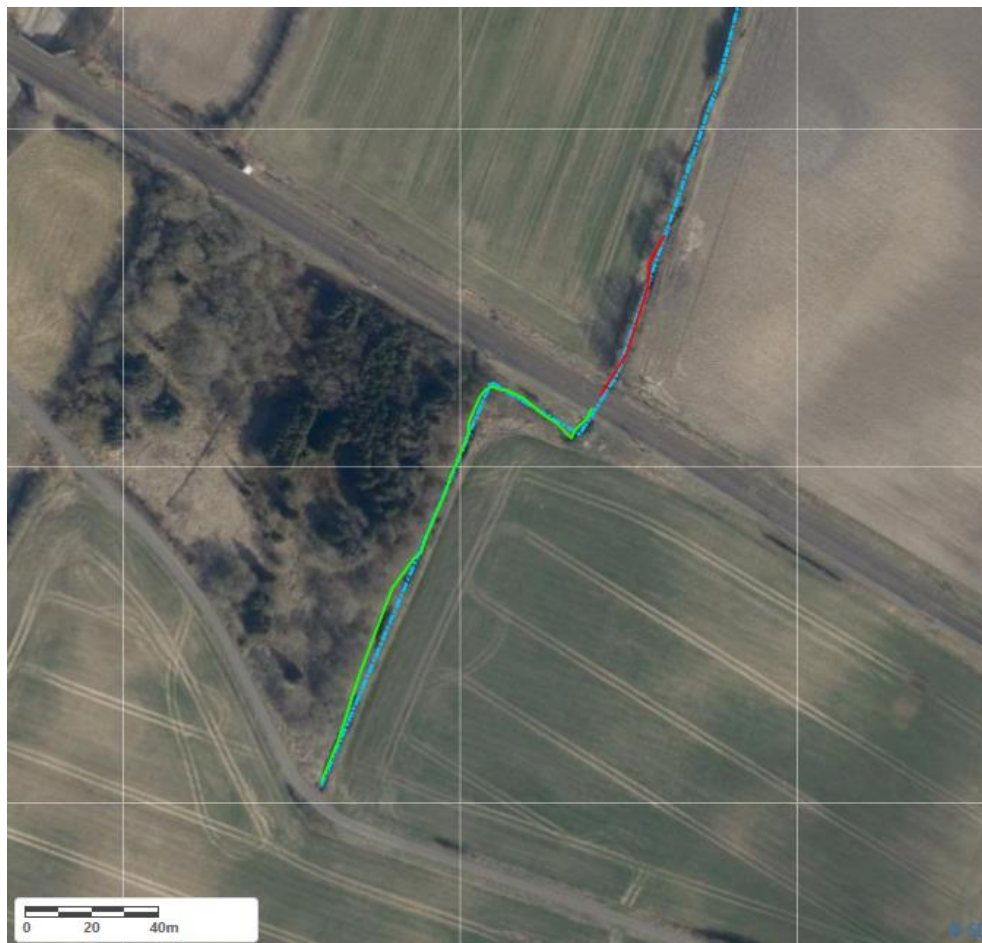
Figur 2-5 Vandløbsstrækning af Magtenbøllefløbet, hvor der udføres vandløbsrestaurering. Grøn linje angiver vandløbsstrækning nedstrøms jernbaneoverkørslen, fra st. 4935 til st. 5104, hvor vandløbsbunden hæves, så der opnås et jævnt fald på 6,8 ‰ med udlæg af blandede sten, mens rød linje angiver vandløbsstrækning opstrøms jernbaneoverkørslen, fra st. 4870 til st. 4920, hvor vandløbsbunden sænkes, så der opnås et jævnt fald på 4,6 ‰ med udlæg af blandede sten og gydegrus.
