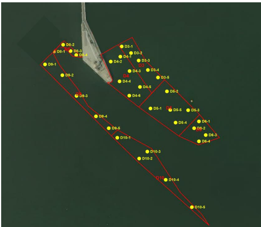
Figur 2.1 Delområder for udtagning af sedimentprøver. Indenfor hvert delområde er der udtaget 4 – 6 sedimentprøver til ca. 0,5 meter ned i havbunden. Prøver indenfor hvert delområde er puljet og analyseret samlet.
