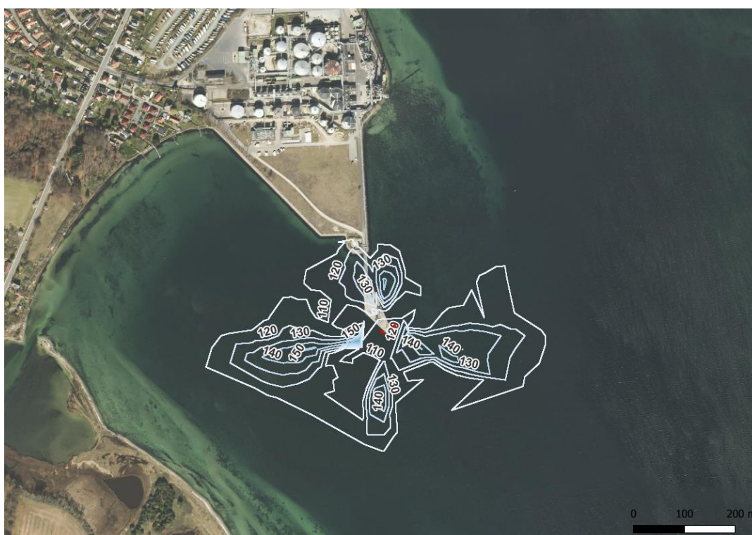
Figur 12-4: 0-alternativ: 19. højeste timemiddelkoncentration af NO 2 i µg/m 3 . Ved tillæg af baggrundskoncentrationen på 25 µg/m 3 kan det ses at luftkvalitetskravet på 200 µg/m 3 er overholdt for hele det beregnede område.
