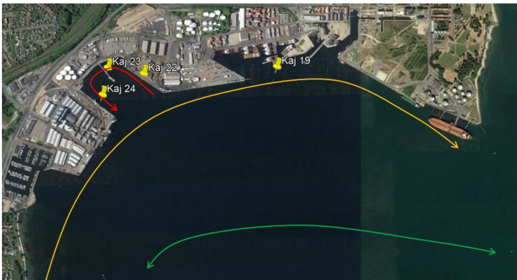
Figur 4-23: Det primære strømningsbillede for kaj 23 og ud mod strømmen i Lillebælt, hvor rød markerer strømningerne i Centerhavnen ved kaj 23, orange markerer de langsgående strømninger og den grønne viser strømmingen i Lillebælt.
