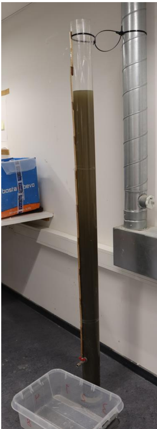
Figur 4-14: Forsøg med materialet ved kaj 23 i Andresenrør: Billedet viser det opløste materiale efter adskillige omblandinger. Der udtages prøver i bunden til bestemmelse af faldhastighed. Materialet er taget fra boring B1 i kote -9.7m (prøve nr. 57 udtaget ca. 11,5 m under dæk, dæk i +1,8 m og havbund i -7,3 m).
