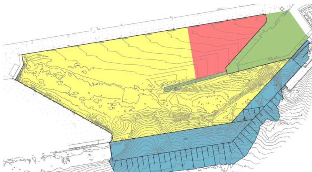
Figur 4-3: Opfyld og erosionssikring.
