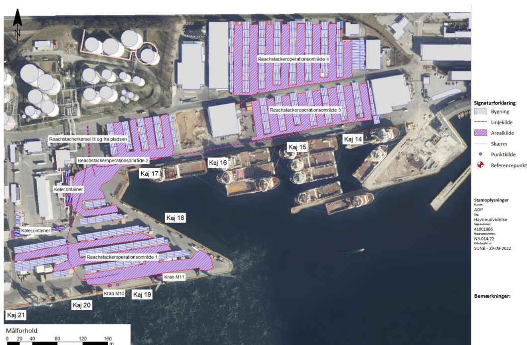
Figur 12-1: Oversigtskort over containerhåndtering i 0-alternativ. De røde og lilla skraveringer/stiplede linjer viser placering af støjkilder. Grå firkantede bygninger med blå kanter viser bygninger. Samme kort findes i Bilag 4 i høj opløsning, hvor det er muligt at studere de nærmere detaljer.
