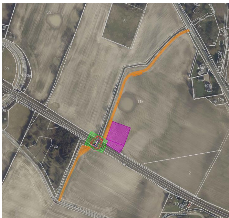
Figur 1: Arbejdstegning for udskiftning af jernbaneoverkørsel. Orange skravering = adgangsveje samt vige- og vendepladser, grøn skravering = arbejdsområdet, lilla skravering = arbejdspladsarealet, rød linje = afgravningslinje til terræn.
