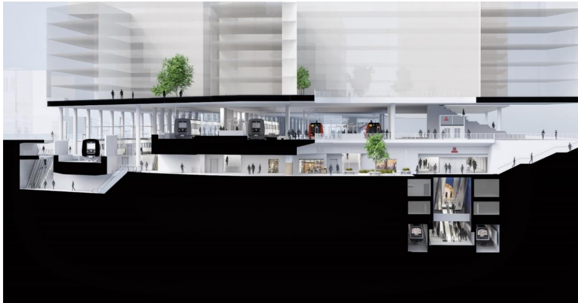
Figur 3-3 3D-model. Tværsnit af den fremtidige Concourse Hall ved Ny Ellebjerg Station. Fra venstre mod højre ses projektet i form af nye perroner, hvor der holder ét hvidt tog, samt elevatorer og trapper til gangtunnel under Øresundssporene. Derefter ses fra venstre mod højre Concourse Hall med København-Ringsted-banen, hvor der holder to hvide tog, Ringbanen, hvor der holder to røde tog, samt Metroen (underjordisk), hvor der holder to hvide tog. Bemærk, at der siden udarbejdelsen af 3D-modellen er sket enkelte ændringer, herunder er det ikke afklaret, om der kommer bebyggelse over jernbanesporene.
