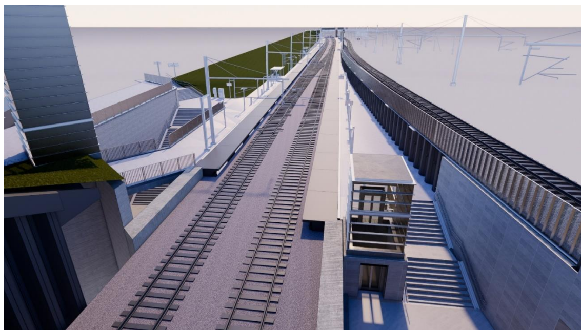
Figur 3-1 3D-model. Projektet ses fra Køge Bugt-banen mod Gammel Køge Landevej, dvs. fra øst mod vest. I midten ses de to Øresundsspor – det venstre er det sydlige i østlig retning mod København H, og det højre er det nordlige i vestlig retning mod Høje Taastrup. De to Øresundsspor er omgivet af de to nye sideperroner. Følager ses til venstre for den sydlige sideperron. Ud for den nordlige sideperron ses dennes trappe og elevator til gangtunnelen. Bemærk, at der siden udarbejdelsen af 3D-modellen er sket enkelte ændringer. En eventuel ny forplads ved Følager er ikke en del af projektet.
