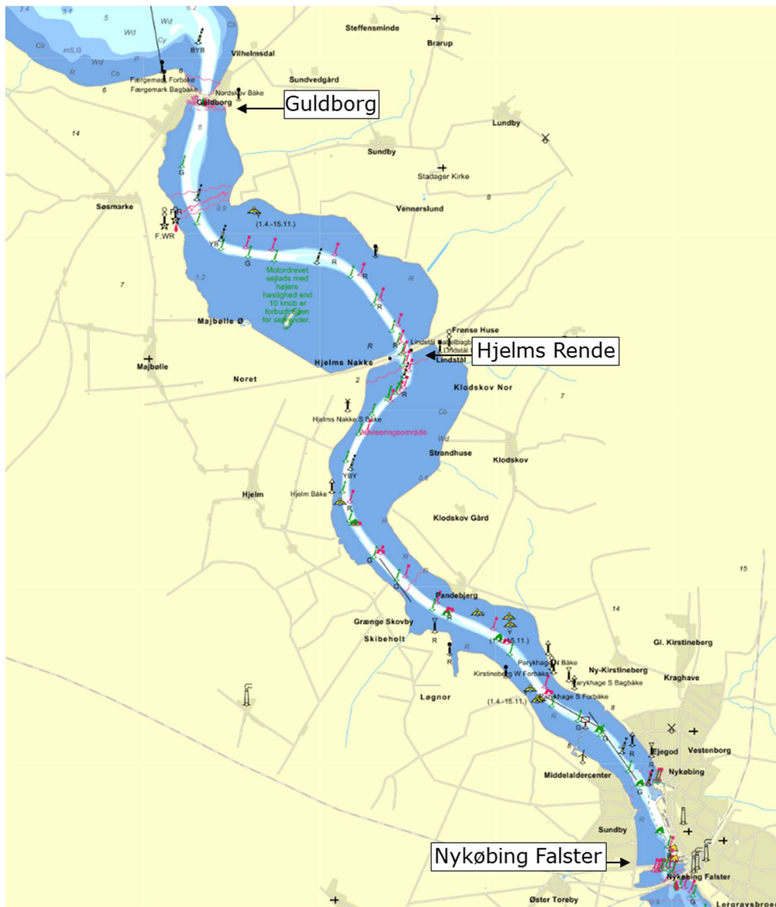
Figur 6-17. Eniro søkort med vejledende sø afmærkninger langs sejltrenden i Guldborgsund for passage i nord- og sydgående retning mellem Smålandsfarvandet og Nykøbing Falster /42/, /43/.
