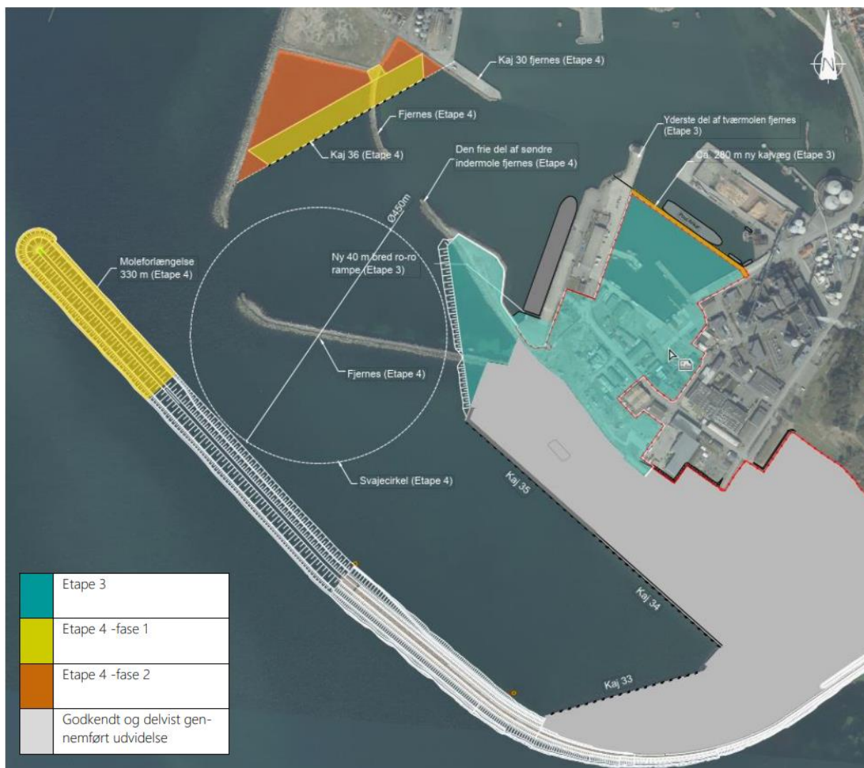
Figur 5.1 Arealudvidelserne og nye kajer i Etape 3 (blågrøn) og moleforlængelse, svajebassin og ny Kaj 36 i Vesthavnen i Etape 4 (gul/orange). Tidligere godkendte og delvist gennemførte udvidelser vises med lys grå.
