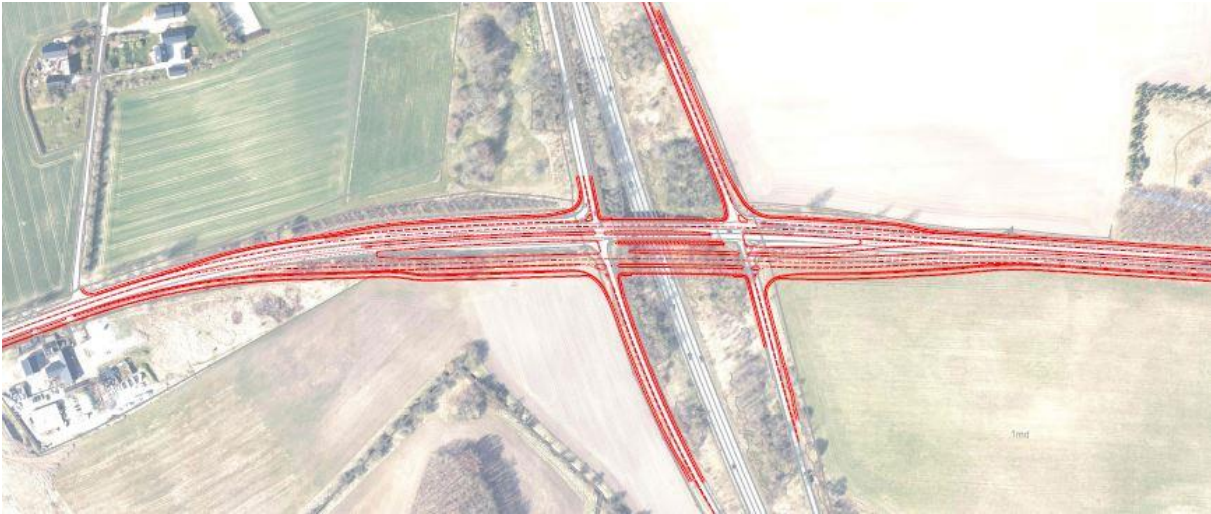
Figur 16: Ændringer af brooverførslen over Hillerød motorvej/Roskildevej.
