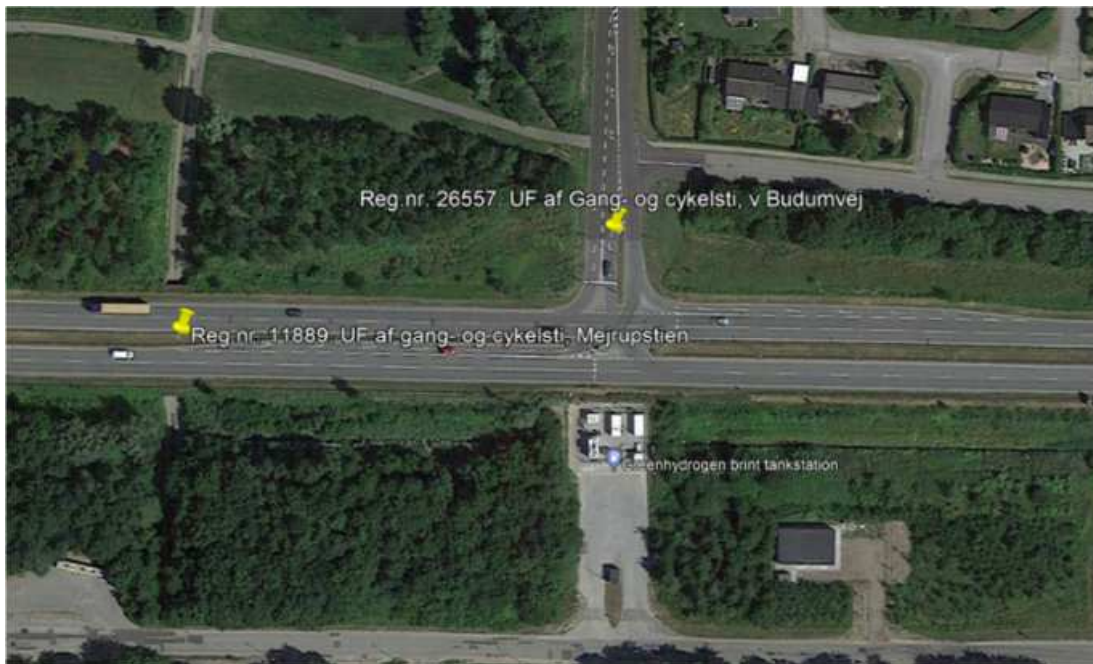
Figur 39: Kryds 3. Mejrupstien sideudvides, mens Gullestrupstien føres under Budumvej en ny tunnel.
