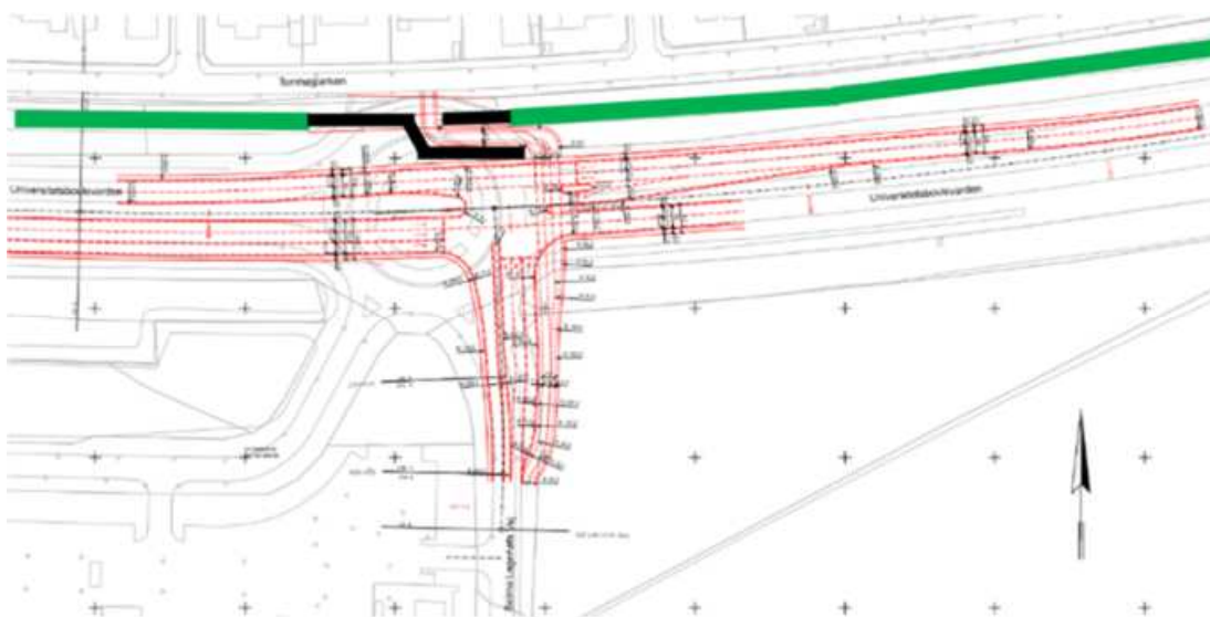
Figur 43: Støjskærmssluse på nordsiden af kryds 4 markeret med sort linje. Grøn linje er eksisterende støjvold.
