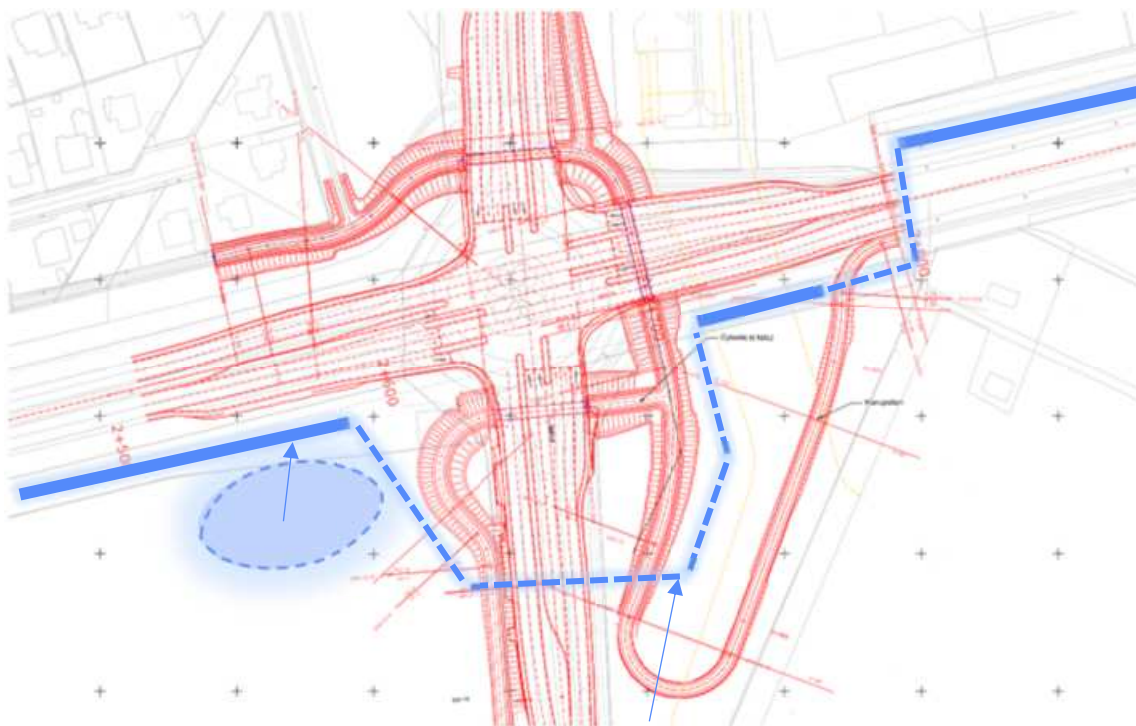
Figur 15: Placering af forsinkelsesbassin for kryds 5 med drossel udledning til Toppentuebækken.
