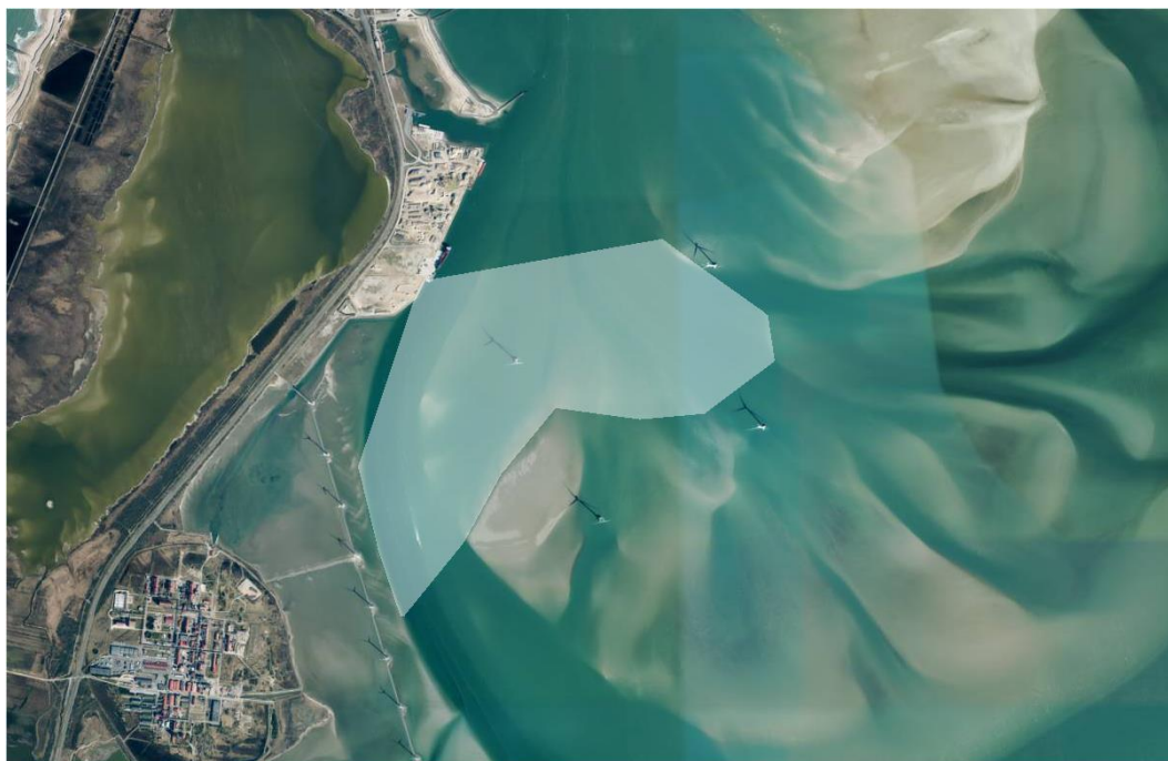
Figur 6: Område for støjdbredelse i forbindelse med installering af spuns
