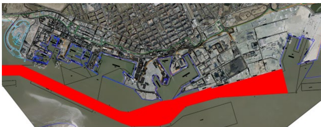
Figur 4-3 Uddybningsplan for område 1 og 2. (Esbjerg Havn, Udbudsmateriale af 17. januar 2023 - Kravspecifikationer med beskrivelse af uddybningsentreprisen, 2023).
