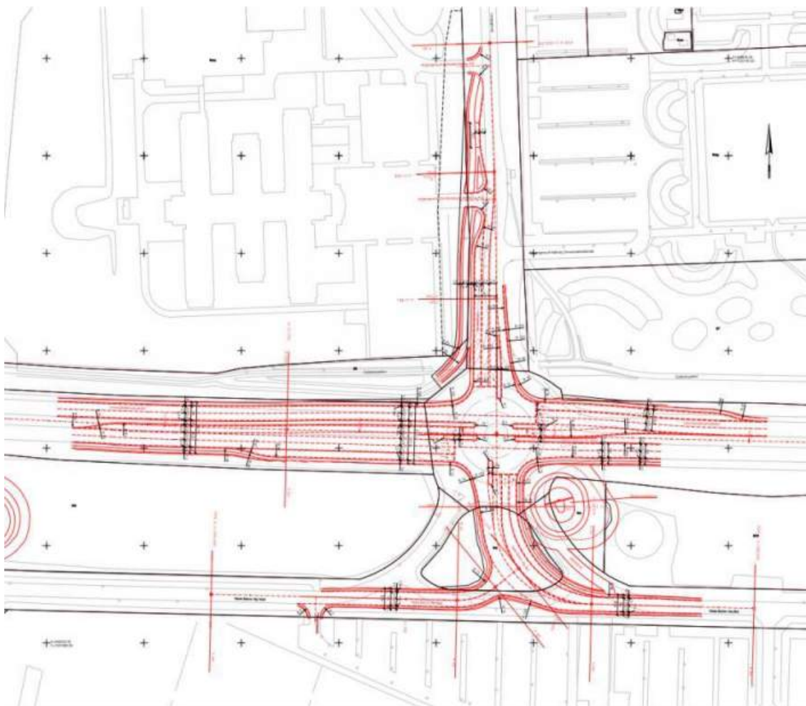
Figur 3.3: Kryds 2 - Universitetsboulevarden/Langagervej/Niels Bohrs Vej, som signalreguleret F-kryds. Se Tegning H50513-4005.
