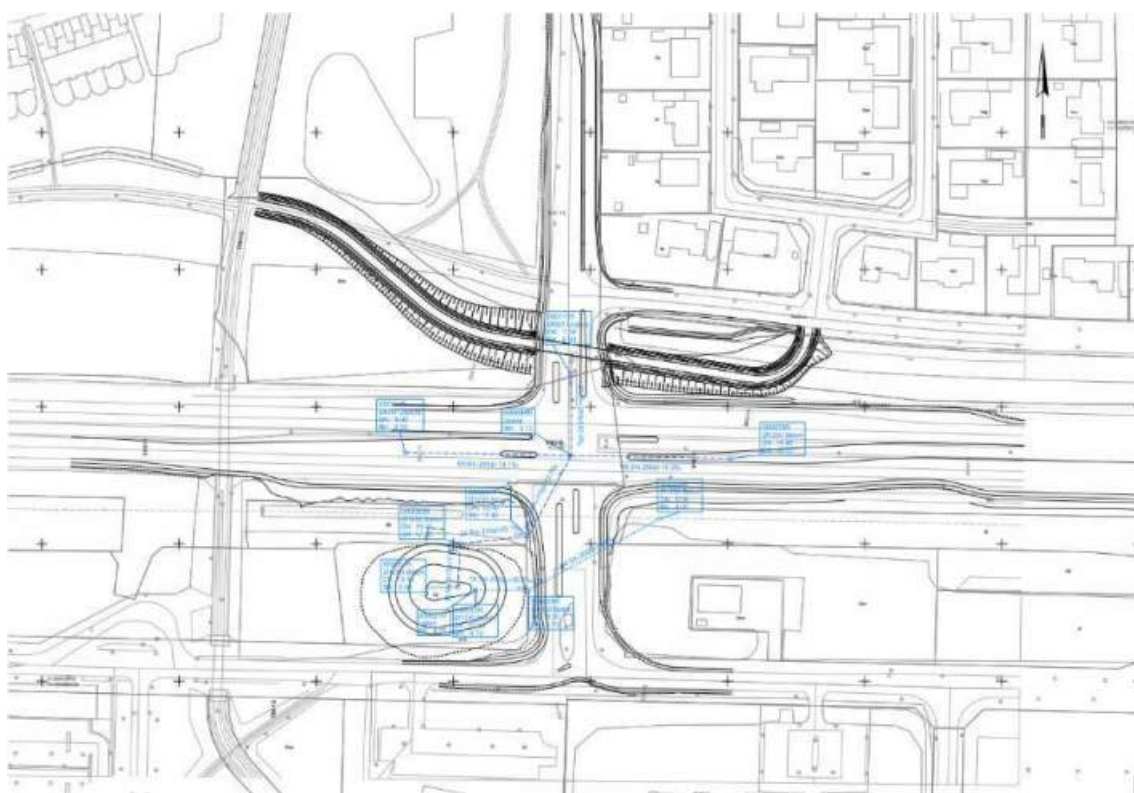
Figur 5.4: Placering af forsinkelsesbassin for kryds 3 med droslet udledning til Toppentuebækken (kvl). Se Tegning H50513-35006.
