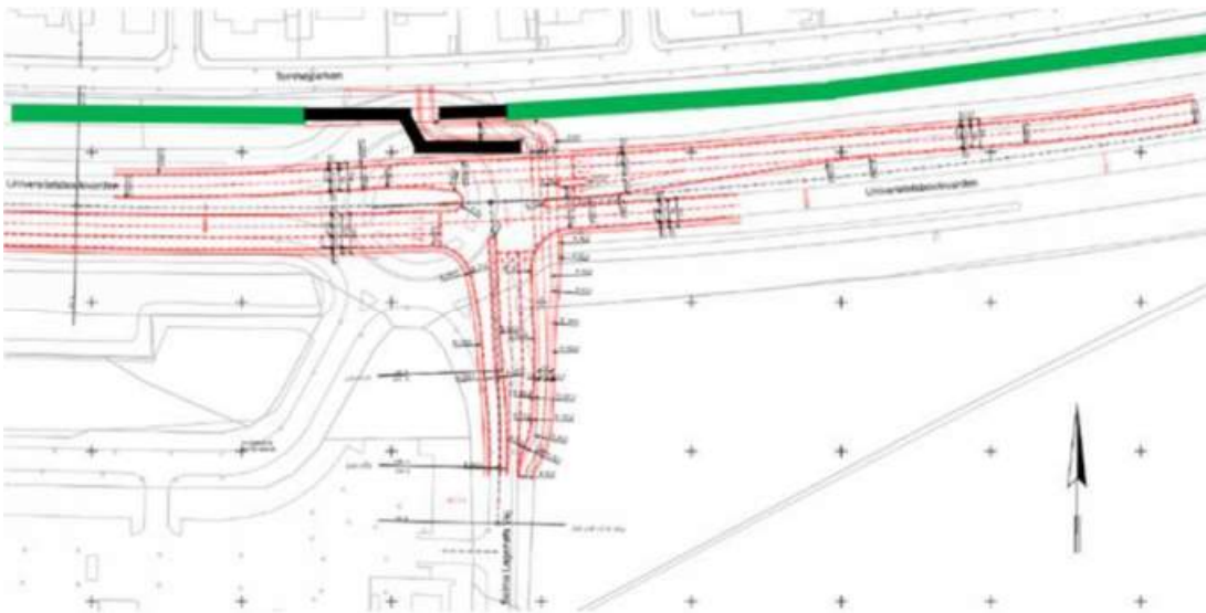
Figur 10.2: Støjskærmsluse på nordsiden af kryds 4 markeret med sort linje. Grøn linje er eksisterende støjvold.
