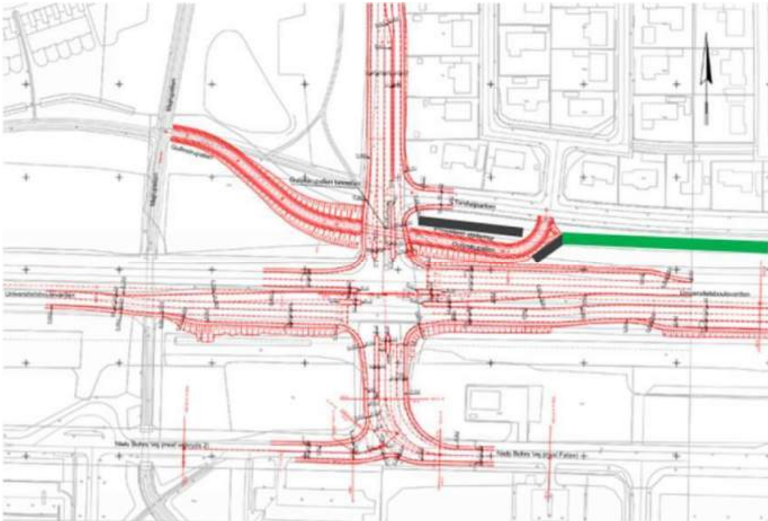
Figur 10.1: Støjskærm ved kryds 3 markeret med sort linje. Grøn linje er eksisterende støjvold. Støjskærmens dimension og placering præciseres i detailprojekteringen.
