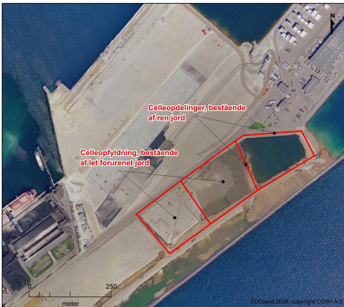
Figur 16-3 Eksempel på opdeling af Østhavnen i 2006 med celleopdeling, bestående af ren jord og opfyldning med let forurennet jord i cellerne.
