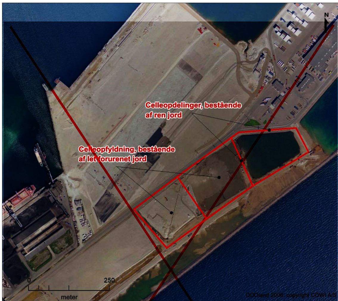
Figur 16-2 Eksempel på opdeling af Østhavnen i 2006 med celleopdeling, bestående af ren jord og opfyldning med let forurenet jord i cellerne.
