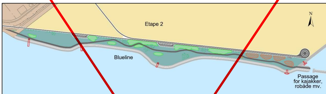
Figur 5-12 Overordnet skitse Aarhus BlueLine på Yderhavnen. BlueLine og det tilhørende plantebælte ses langs ydermolen's inderste, sydvestlige strækning. Passage gennem Sydmoen er ligeledes vist. Passagen er permanent. Illustration fra Aarhus Havn. Vedr. vejanlæg henvises til afsnit 5.2.7.
