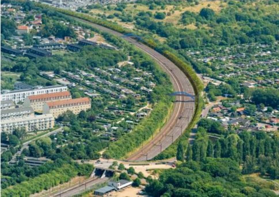
Figur 2.1: Visualisering af overhalingsporet med stibroer indtegnet med blå og med ung beplantning.
