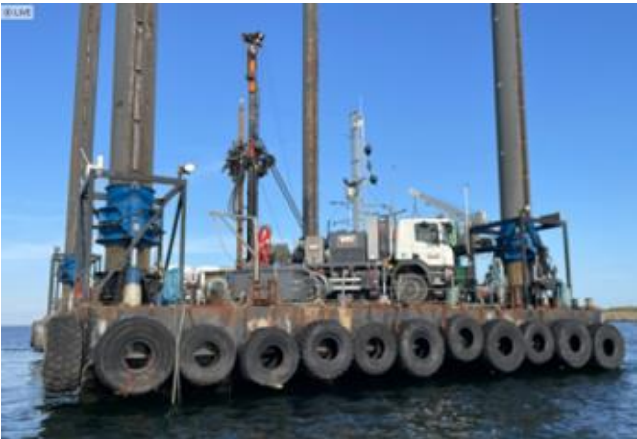
Figur 2: Geoteknisk boring fra Jack-up pram. Pramdens 4 ben sættes på havbunden, hvorefter prammen hæves op så den står stabilt, upåvirket af bølger og strøm. Boreværk monteret på lastbil midt i billedet. Ud over boreværket kan prammen være udstyret med containers til vandrensning, mandsskabsskure, strømforsyning mv. Københavns Nordhavn august 2023.
