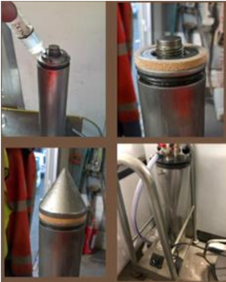
Figur 4: CPT-sonde. Under nedpresningen måles en række parametre, som giver data om geologien. Det orange lag under sondens spids er et filter, der anvendes til måling af trykforhold i geologiske lag, som er en af de mange parametre der kan måles med metoden. Foto: Fra GEO præsentation (hentet på google).
