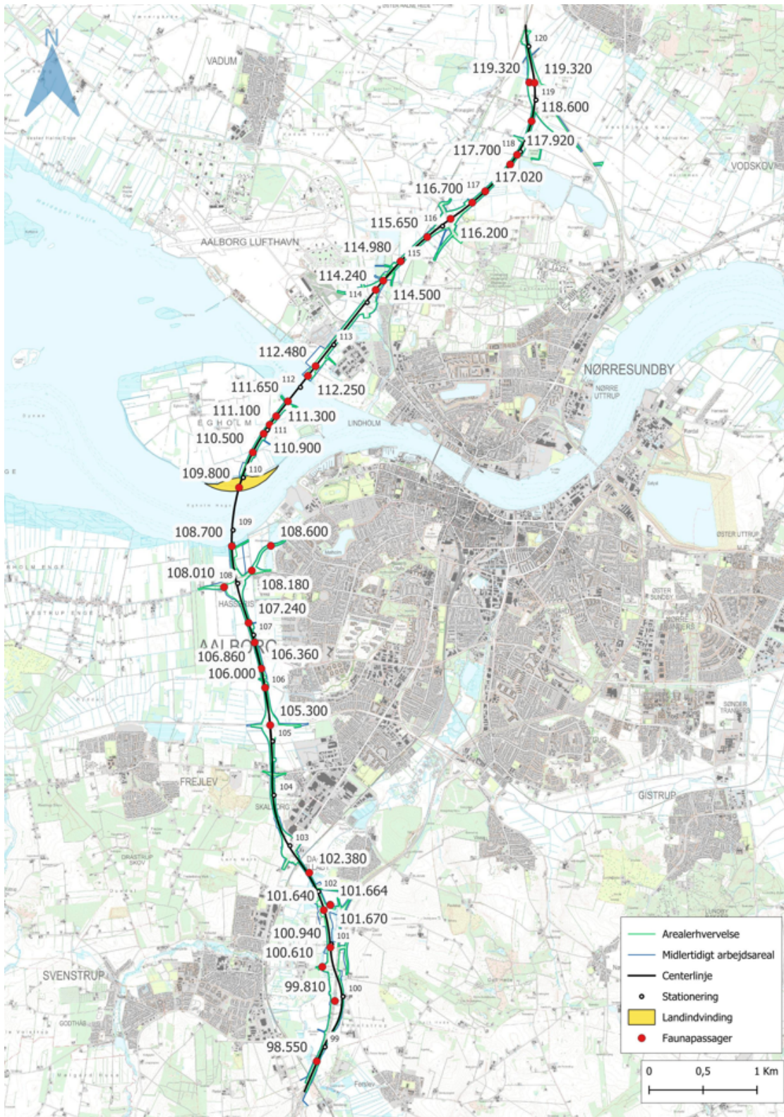
Figur 2-2 Faunapassager langs den 3. Limfjordsforbindelse.
