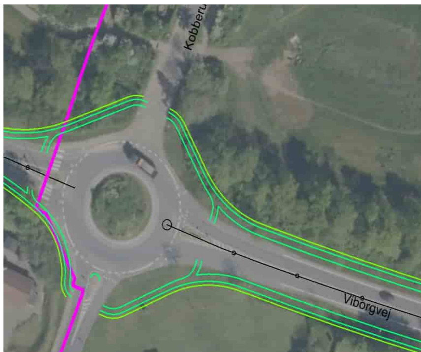
Figur 3: Eksempel på krydsende hovedtransmissionsledning i rundkørslen ved Mejrup.
