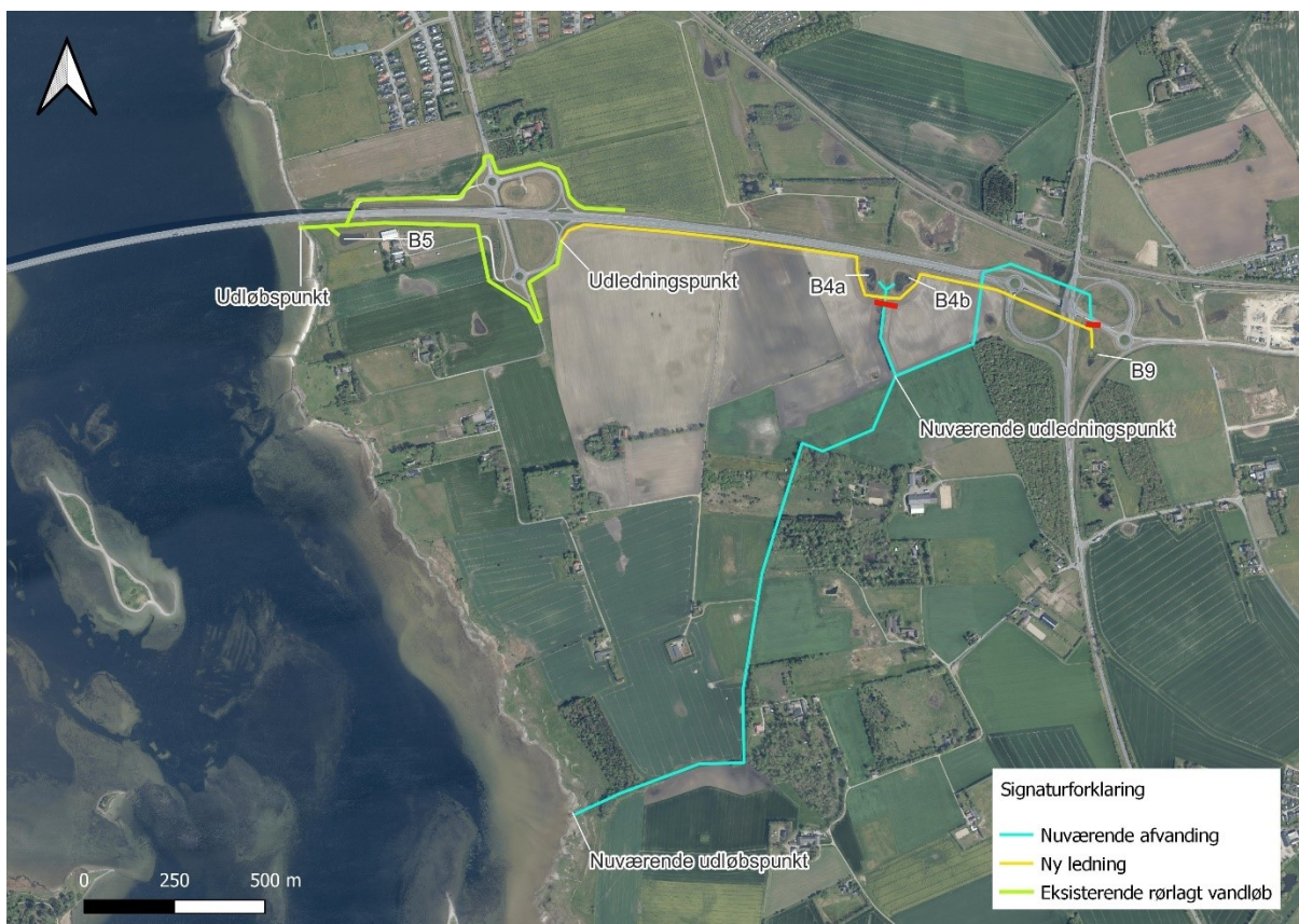
Figur 1.1 Oversigt over nuværende vandløbsstrækning med forbindelse til bassiner samt ny projekteret ledning. De røde streger markerer at bassinerne frakobles Markbækrenden.
