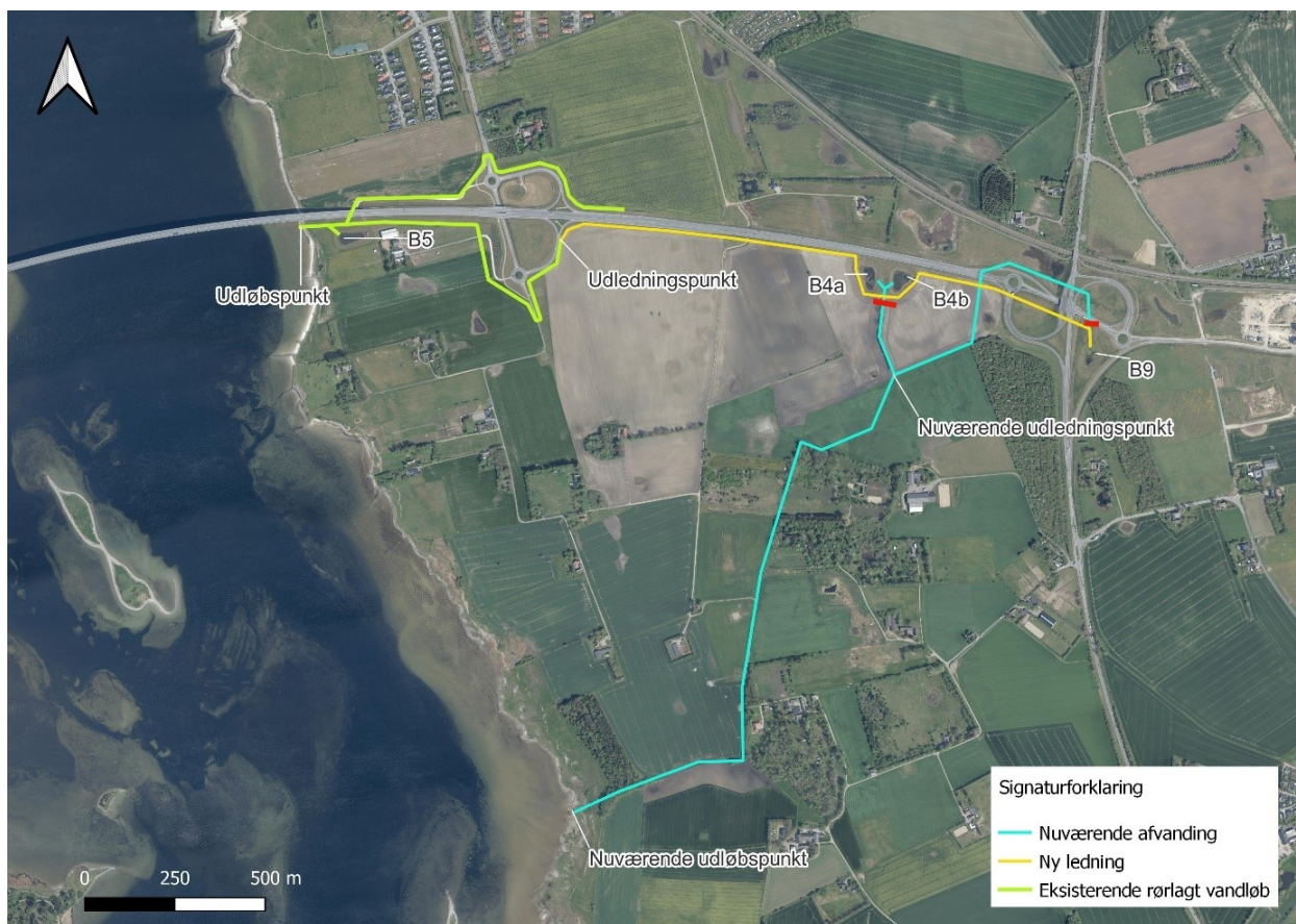
Figur 1. Placering af de 4 regnvandsbassiner, eksisterende rørlagt vandløb med udløbspunkt ved Roskilde Fjord, ny ledning med udledningspunkt på det rørlagte vandløb. De røde streger markerer at bassinerne frakobles Marbækrenden (vist med blå).
