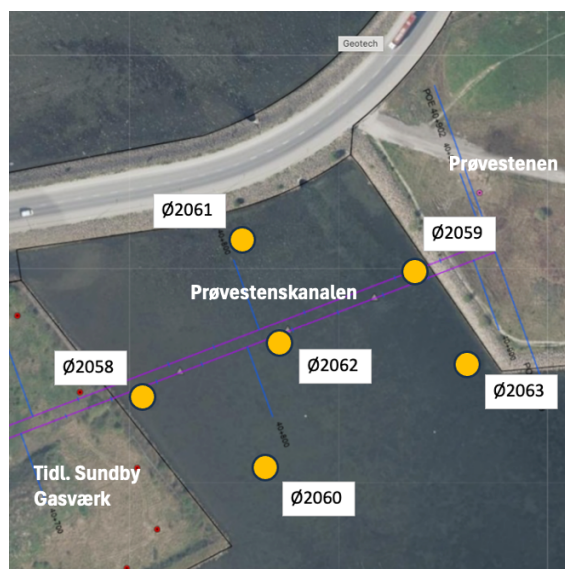
Figur 1b: Placering af boringerne Ø2058-Ø2063 i Prøvestenskanalen.
