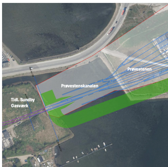
Figur 1a: Opfyldning af Prøvestenskanalen for forbindelse til kontrol- og vedligeholdelsescenter (KVC) på Prøvestenen.
