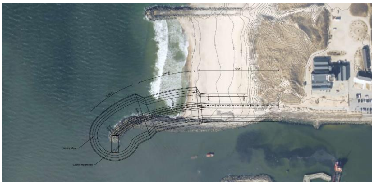
Figur 3-1: Eksisterende (ortofoto) og fremtidig Nordre mole i Thorsminde Havn (Ref. /4/). Bemærk at den eksisterende mole kun kan ses over vandspejlet, mens delen under vandspejlet ikke kan ses på ortofotoet.
