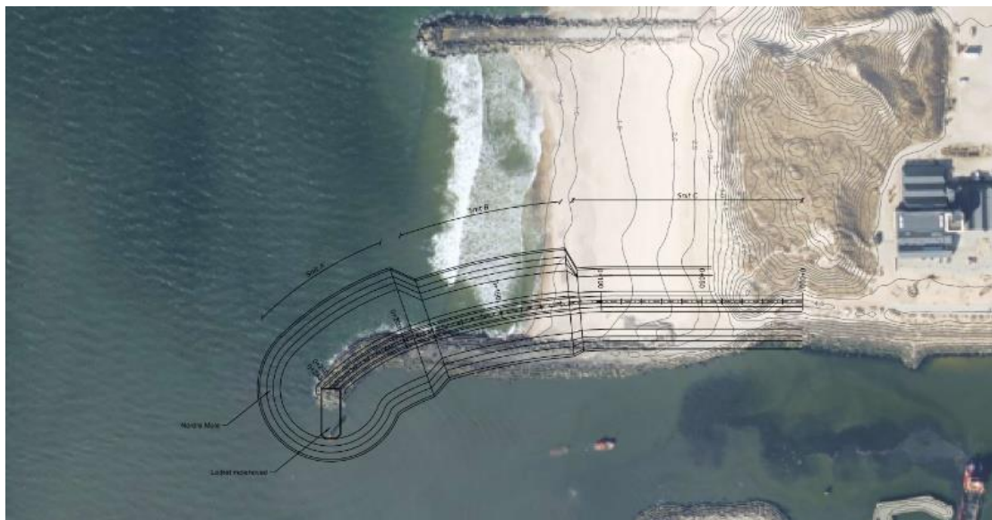
Figur 2-1: Eksisterende (ortofoto) og fremtidig Nordre mole i Thorsminde Havn.
