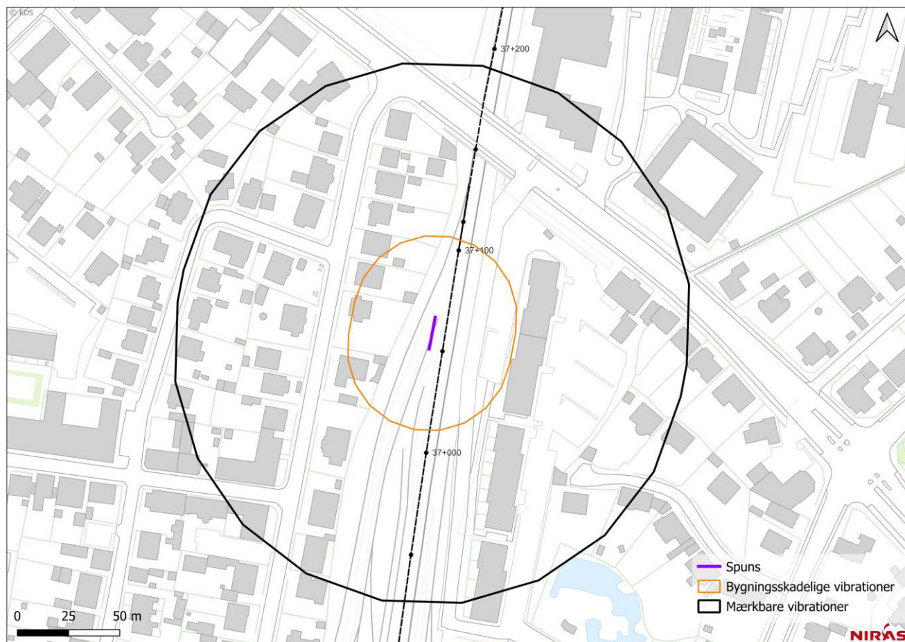
Figur 4.1: Oversigt over afstande med mærkbare vibrationer (orange) og bygningskadelige vibrationer (sort) for vibrering af spuns øst for spor 12.
