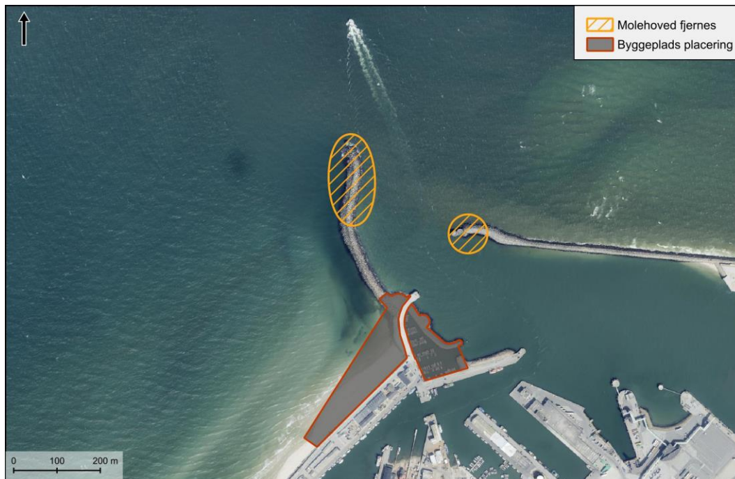
Figur 3-4 Dele af den eksisterende mole og molehoveder som fjernes. Nedbrudte sten placeres midlertidigt indenfor byggepladsarealet.
