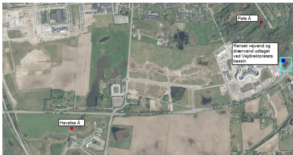
Figur 1 Illustration af prøvetagningsstederne. Prøverne for Havelse Å og Pøle Å blev udtaget direkte i det åbne vandløb. Prøven af det rensset vejvand blev udtaget ved udløbsbygværket fra bassinet og drænvandet blev udtaget fra en drænbrønd lidt opstrøms bassinet
