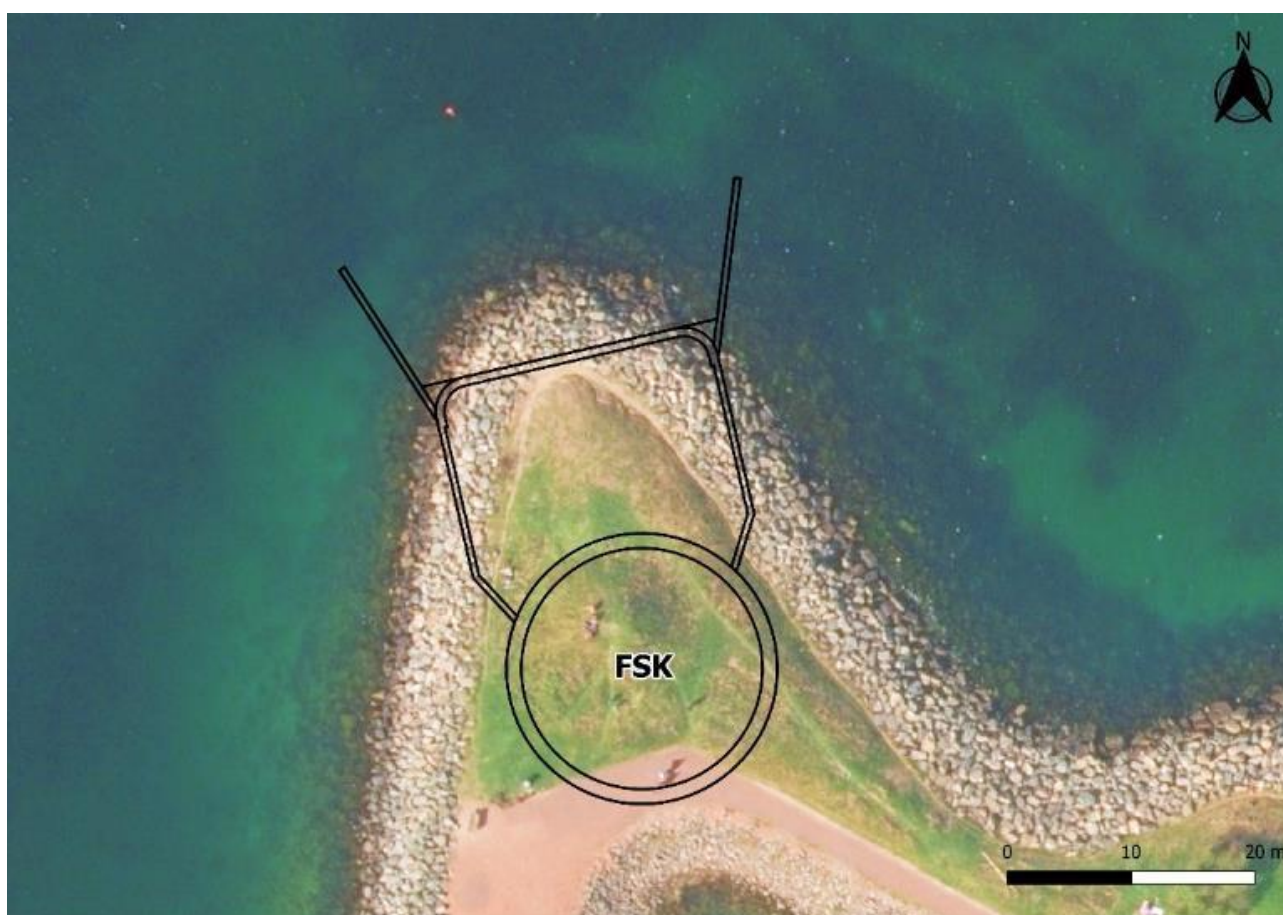
Figur 3: Oversigtskort over skakt, udløbsbygværk og støttmure ved FSK efter nedtagning af midlertidigt opfyld
