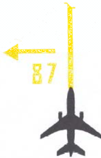
Tilkørselsmarkering til standplads med standpladsnummer. Drej, når cockpit er ud for pilen.
