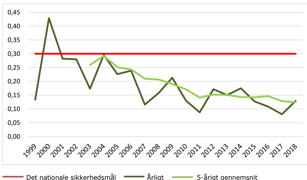
Figur 2.13: Overholdelse af det nationale sikkerhedsmål målt på væsentlige personulykker 1999-2018 (dræbte/skadede pr. mio. tog-km)
