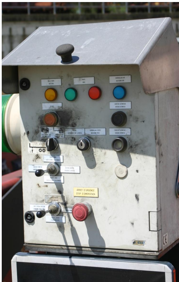
Styring af hydrauliske løft sker fra en pult, som findes placeret ved hver rampe.
