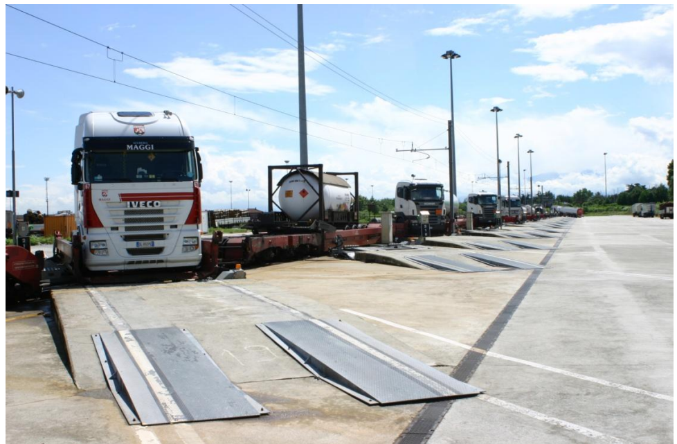
Illustration af Modalohr-konceptet. Bemærk køreledningerne over læssesporet.
