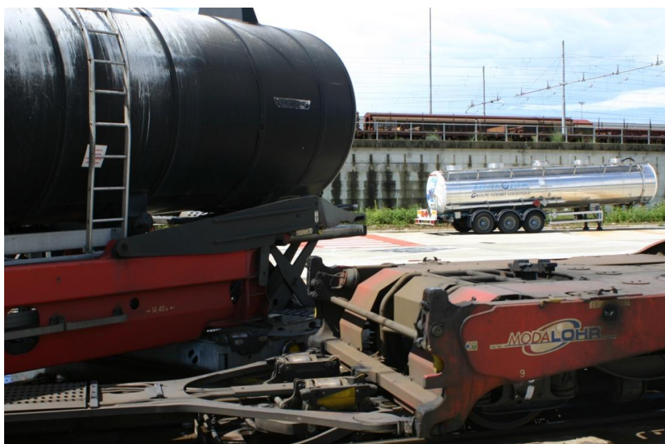
Tanktrailerens løftes under kongebolten, før wagonens drejeskammel igen kan køres tilbage i ret position.
