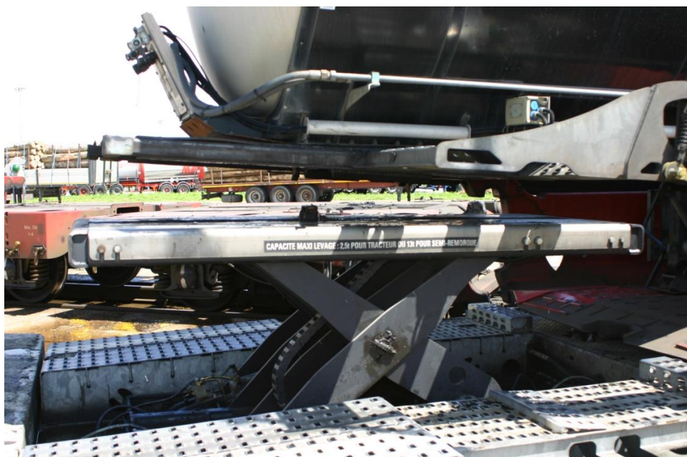
En hydraulisk lift er indbygget i rampen.
