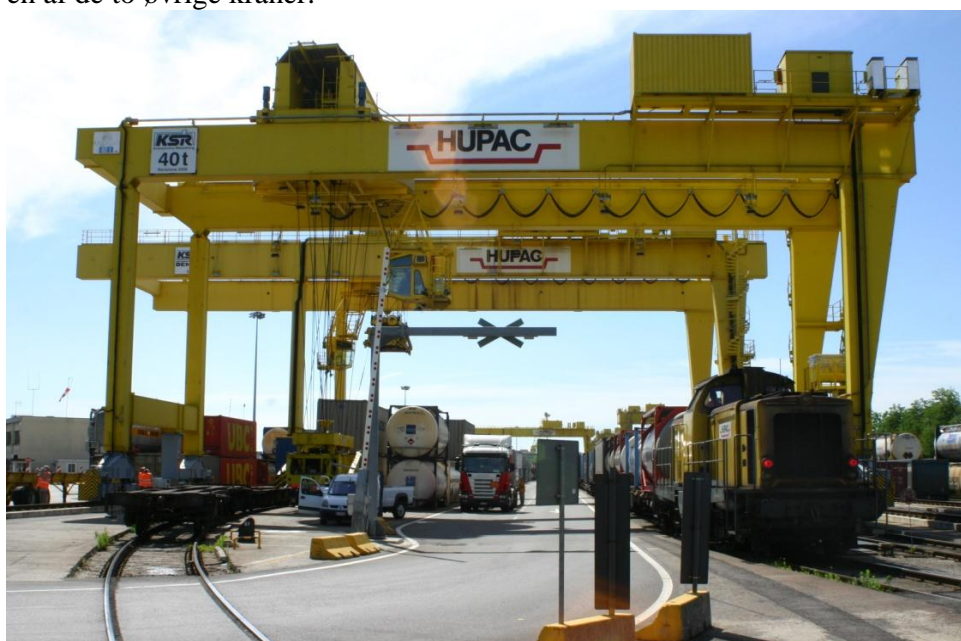
Busto-terminalen. Kranen forrest i billedet er brudt ned, men med yderligere to kraner er den nødvendige krankapacitet fortsat opretholdt.
