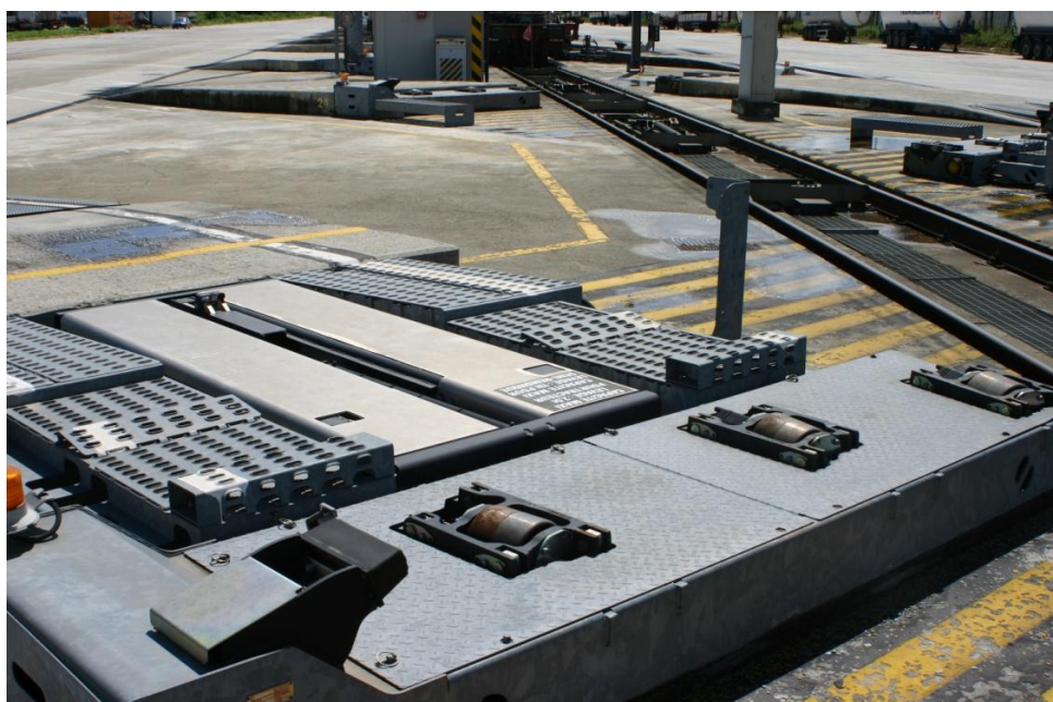
Udover den ovennævnte lift på rampen, er der også monteret ruller som wagnens drejeskammel hviler på, i forbindelse med af- og pålæsning.
