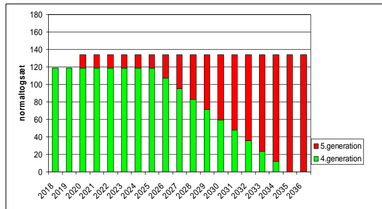
Figur 3. Udskiftning af materiel fra 4. til 5. generation ved totalombygning til S-togsteknologi ifm. samtidig S-udvidelse til Roskilde og Helsingør, ved tidlig beslutning i 2014 med ibrugtagning 2020
