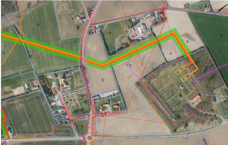
Figur 2: Placering af forsyningskabel fra Energinet Danmarks transformere. De orange markeringer angiver kabeltracé med tilhørende tinglyst servitut, mens den grønne markering er arbejdspladsarealer på ca. 11 m på hver side af kabeltracéet, som erhverves midlertidigt.
