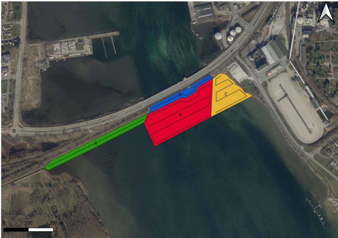
Figur 7-1. Graveplan, hvor der successivt udgraves i rækkefølgen for område B-A-C-D.
