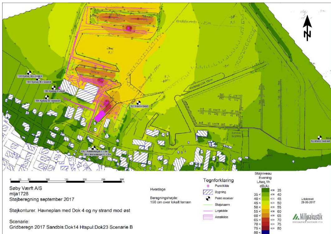
Figur 6-18. Beregnet støjdbredelse for aften og weekend (lørdag og søndag kl. 07-18 og alle dage kl. 18-22). Ved sammenligning med støjgrænser skal niveauerne korrigeres med +5 dB pga. tydeligt hørbar impuls.
