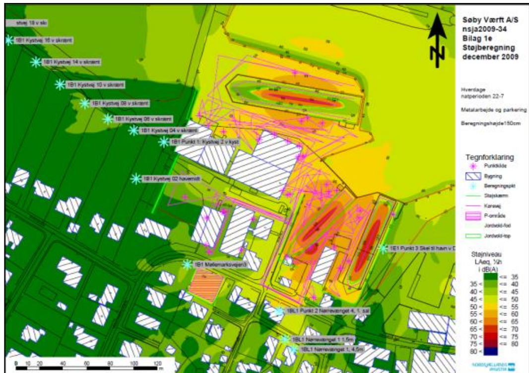
Figur 6-7. Beregnet støjdbredelse for natperioden. Ved sammenligning med støjgrænser skal niveauerne korrigeres med 5 dB pga. tydeligt hørbare impulser.
