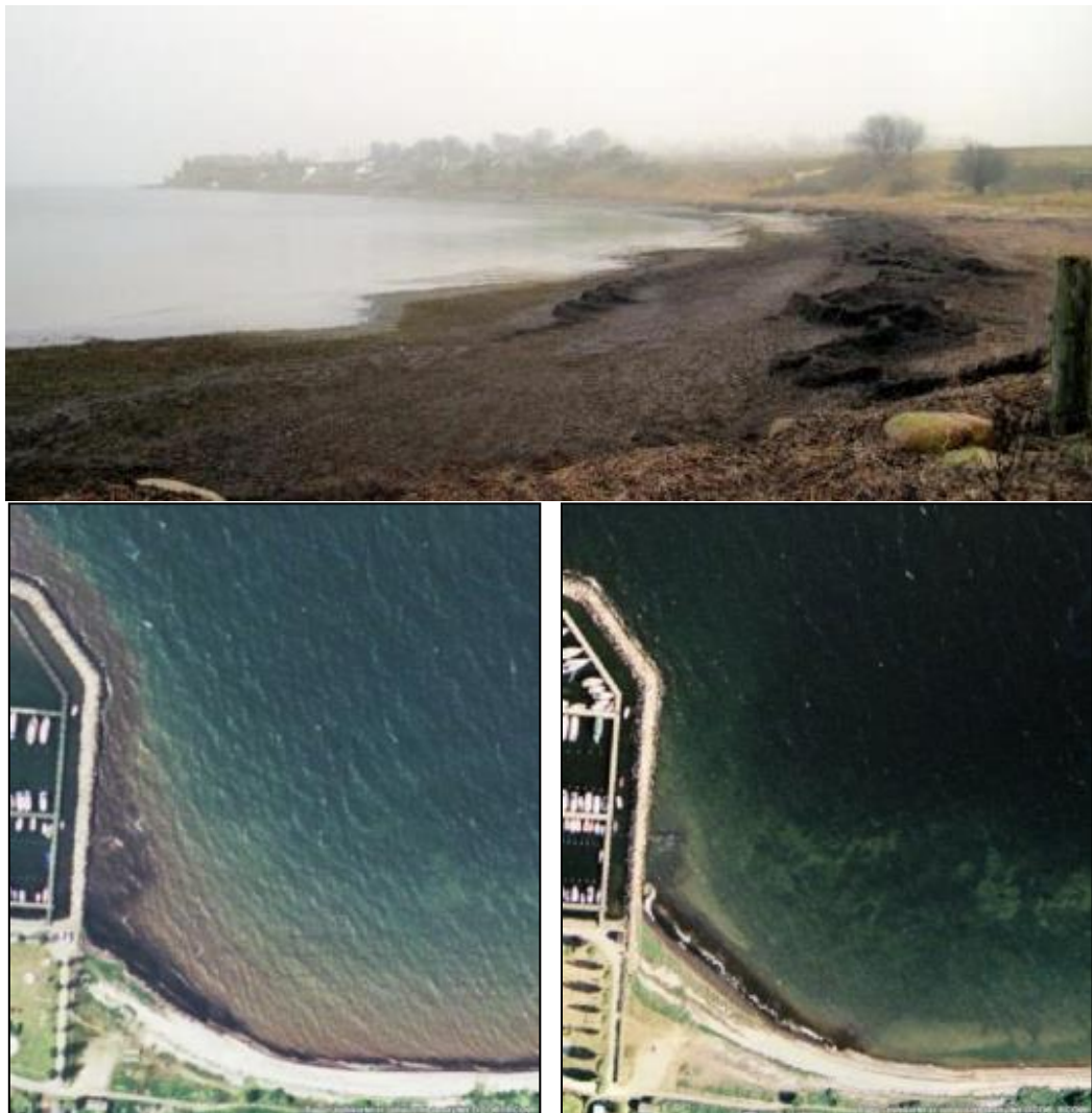
Figur 10-4. Et oversigtsbillede fra marts 2011 samt to ortofotos fra 2002 og 2004 viser, at tangophobningen er størst i hjørnet mellem den eksisterende strand og havnemole 139 .
