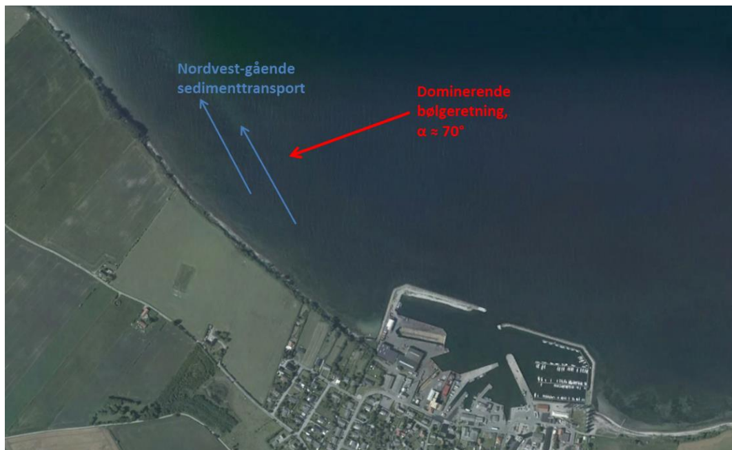
Figur 10-13. Dominerende bølgeretning, samt forventet fremtidig sedimenttransport vest for havnen.
