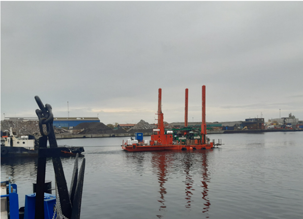
Figur 2: Eksempel på lille jack-up flåde til vanddybder mindre end ca. 3,5 m.
