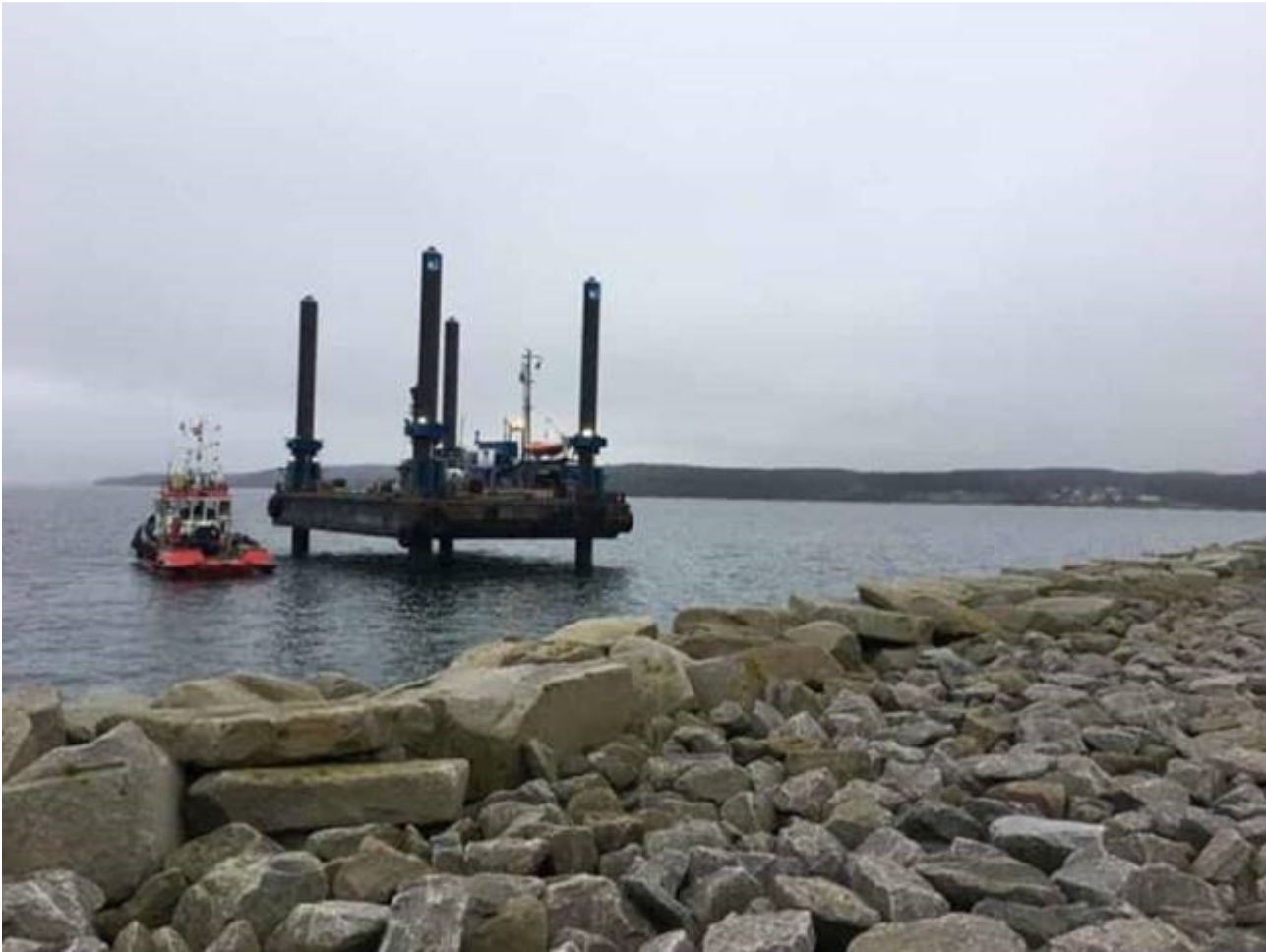
Figur 3: Eksempel på stor jack-up flåde til vanddybder større end ca. 3,5 m.
