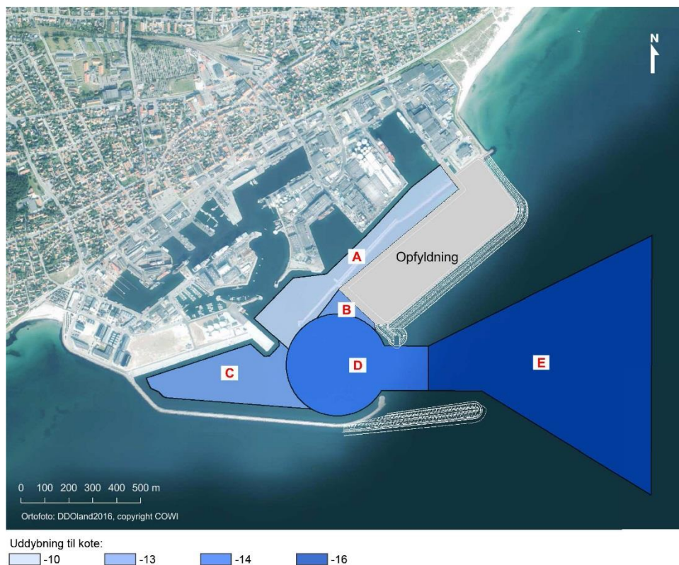
Figur 2 Opfyldnings- og uddybningsarbejder i forbindelse med Etape 3 udvidelsen af Skagen Havn. Uddybningsarbejderne er vist med forskellige nuancer af blå farve, der angiver uddybningsdybden (COWI 2018).
