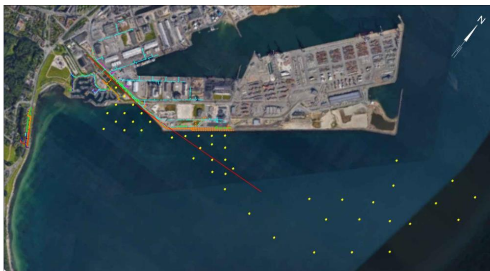
Figur 4 Ledningsplaner indhentet fra LER (forespørgsel nr. 1628190, 26. august 2019). Planlagte boringer er markeret med gule prikker.
