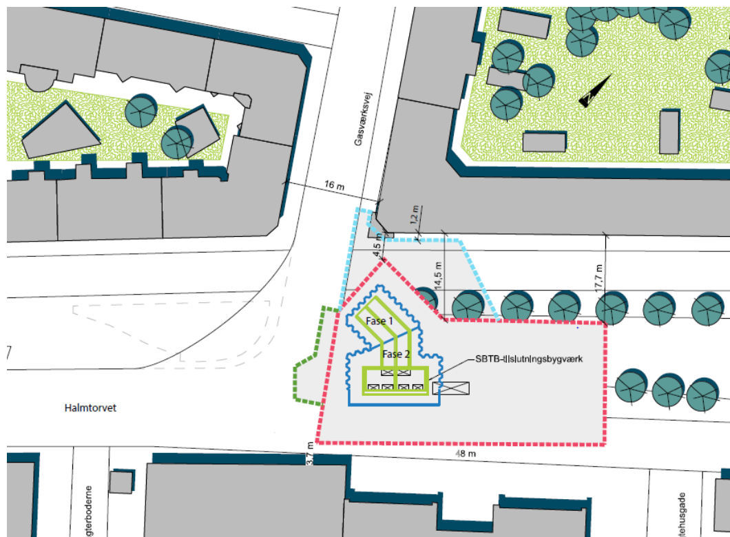
Figur 5.4: Byggepladsen ved Halmtorvet/Gasværksvej i anlægsfase 1, hvor tilslutningsbygværket etableres
