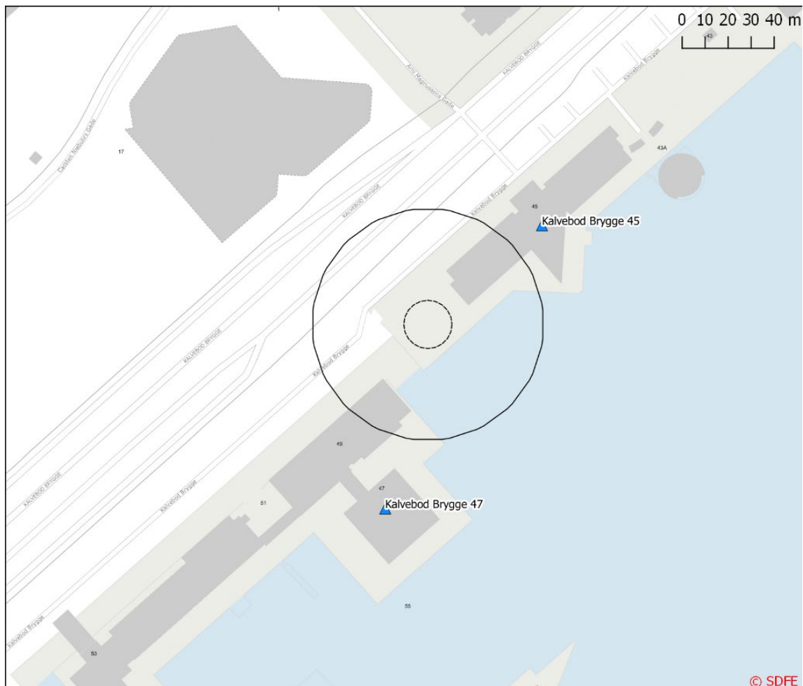
Figur 10.10: Vibrationspåvirkninger fra kapning af opbrydning af kalk ved Kalvebod Brygge. Området hvor der er risiko for vibrationsgener er markeret med sort streg og ligger i en afstand af op til 40 m fra den vibrationsgivende aktivitet. Potentiel vibrationsfølsom virksomhed er markeret med blå trekant.
