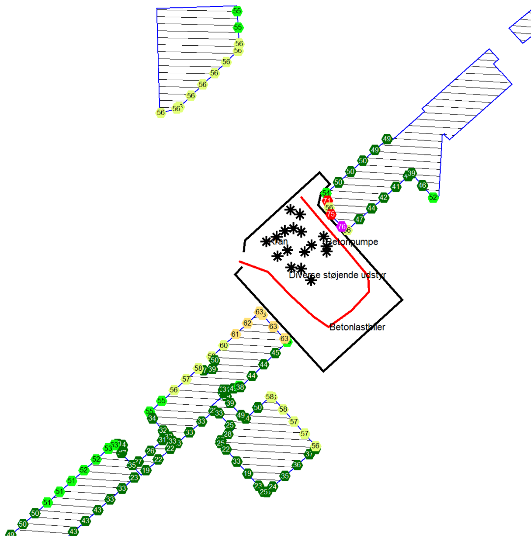
Figur 9.8: Støj fra anlægsarbejder i byggefase 7 for byggepladsen ved Kalvebod Brygge; støbning af skakt. Støjkortet medtager ikke tillæg for hørbare impulser på 5 dB.
