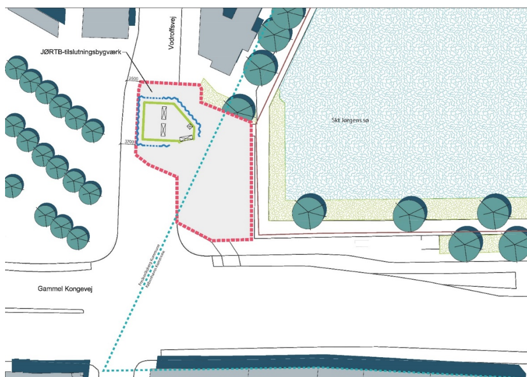
Figur 5.2: Byggepladsen ved Skt. Jørgens Sø i anlægsfase 1, hvor tilslutningsbygværket etableres
