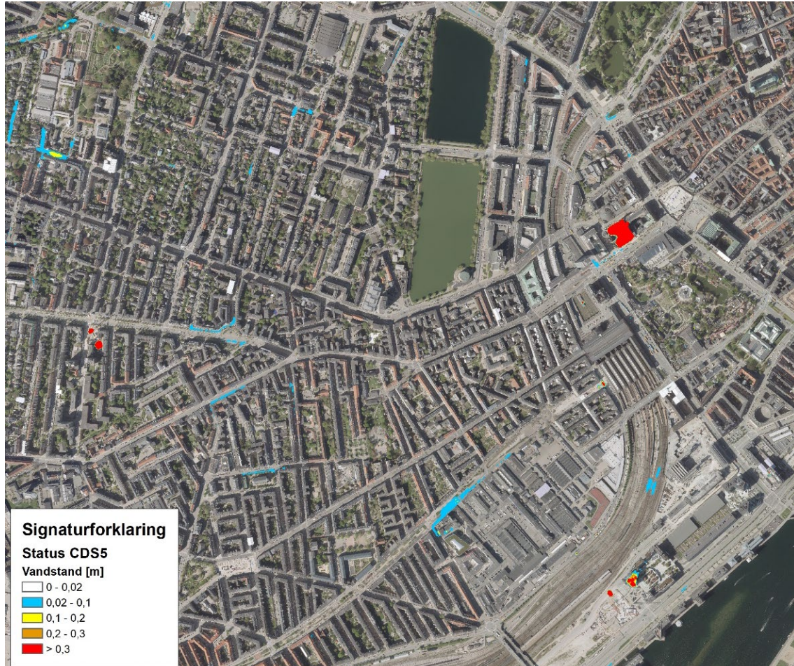
Figur 6.1: Oversvømmede arealer ved en 5-års regnhændelse (CDS) i dagens situation.
