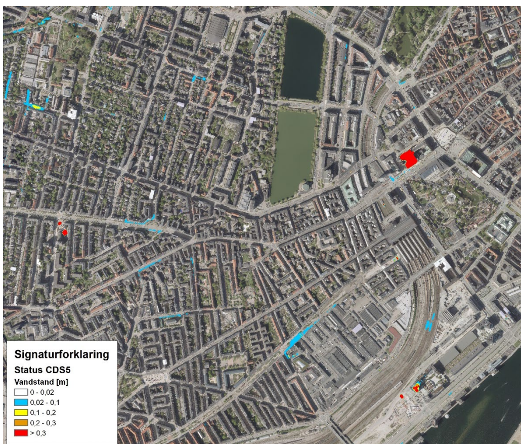
Figur 4-1. Oversvømmede arealer ved en 5-års regnhændelse (CDS) i dagens situation.
