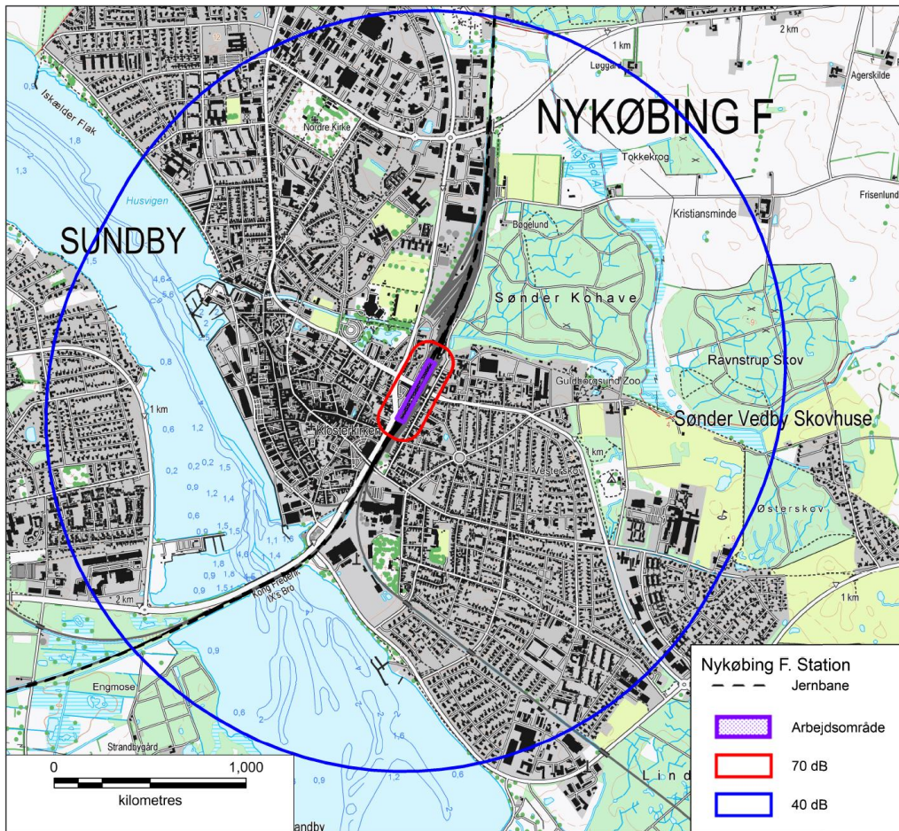
Figur 30. Støj fra nedramningsaktiviteter ved ombygning af Nykøbing F. Station. Boliger indenfor rød og blå signatur kan blive udsat for støj over henholdsvis 70 dB(A) og 40 dB(A).
