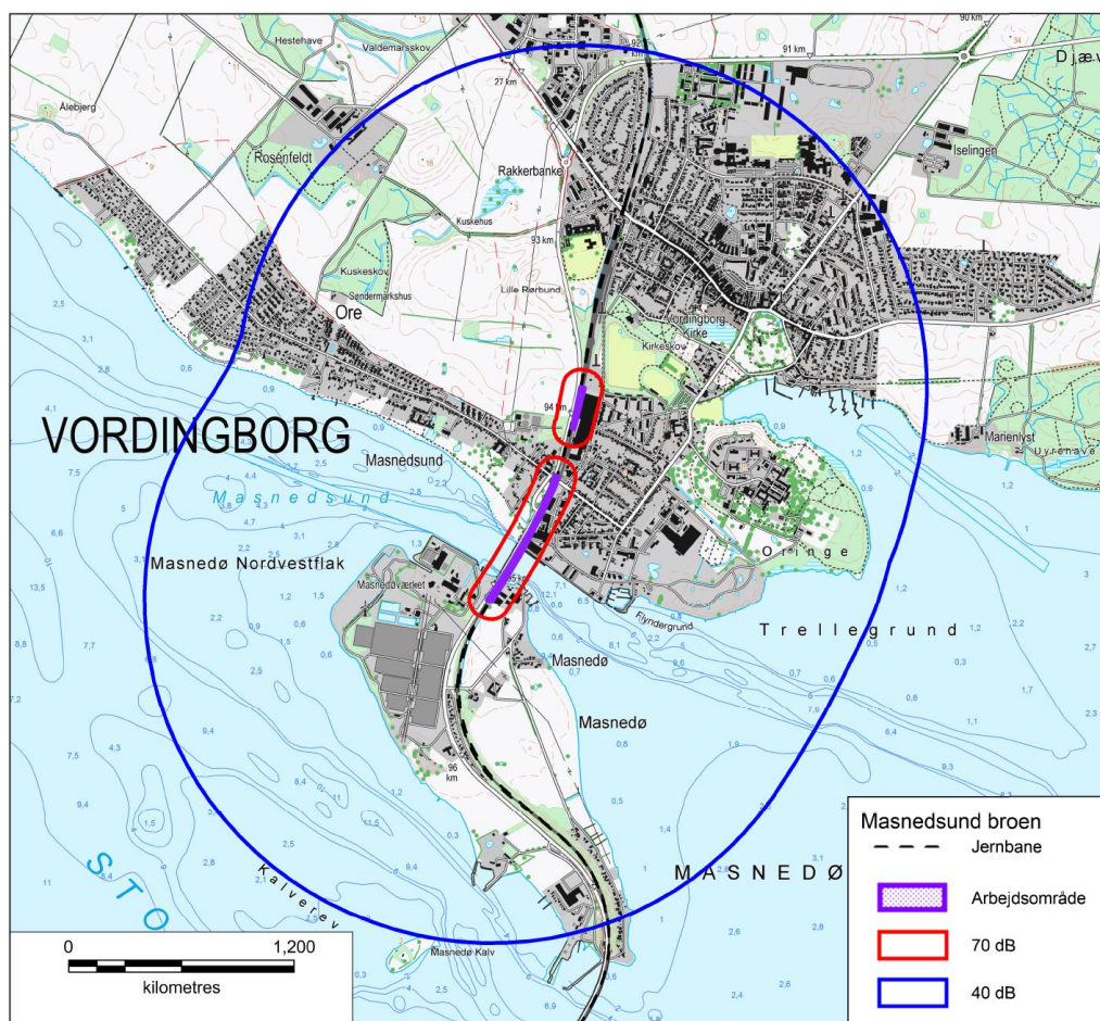
Figur 24. Støj fra nedramningsaktiviteter ved bygning af ny Masnedundsbro. Boliger indenfor rød og blå signatur kan blive udsat for støj over henholdsvis 70 dB(A) og 40 dB(A).
