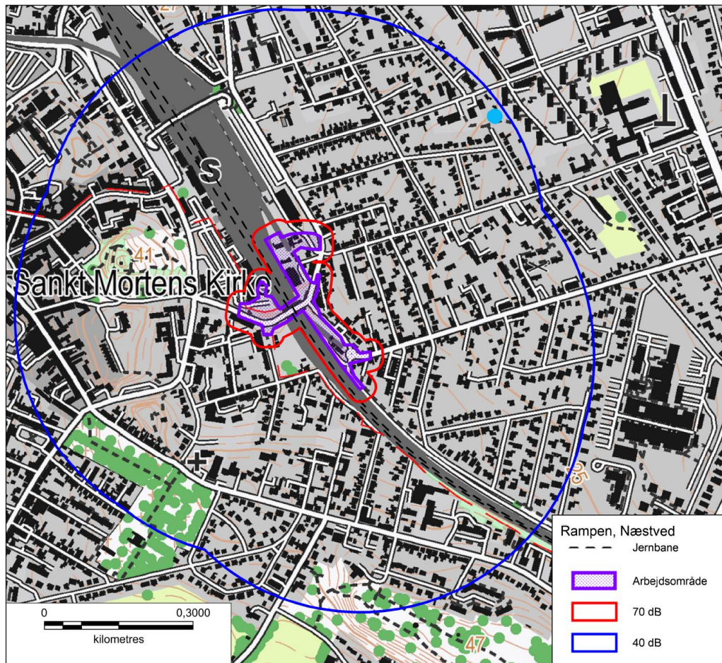
Figur 13. Støj fra aktiviteter ved ombygning af Rampen. Figuren illustrerer støj fra oplagsaktiviteter, jordarbejder, nedrivningsaktiviteter eller konstruktioner. Boliger indenfor rød og blå signatur kan blive udsat for støj over henholdsvis 70 dB(A) og 40 dB(A).
