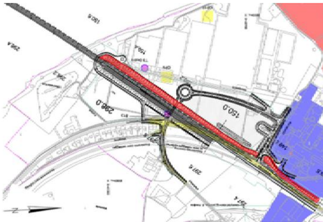
Figur 1: Vej- og broprojekt på Masnedø. Udsnit fra tegning 93200-27501. Det røde område på vejdæmningen angiver, hvor affaldsforbrændingsprodukter kan indbygges.
