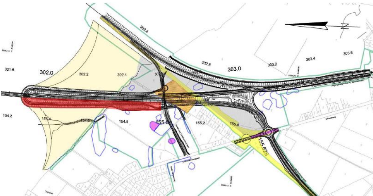
Figur 2: Vej- og broprojekt på Orehoved. Det beige område opfyldes evt. med indvundne havmaterialer. Det røde område angiver, hvor slaggerne kan indbygges
