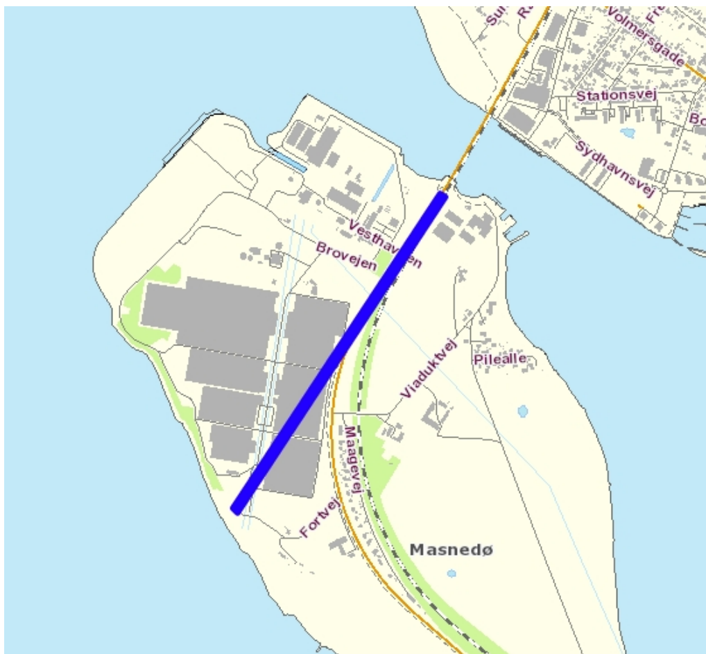
Figur 1. Vej- og broprojekt på Masnedø. Den blå linje angiver placeringen af den nye vejdæmning, hvortil der kan anvendes affaldsforbrændingsslugger.
