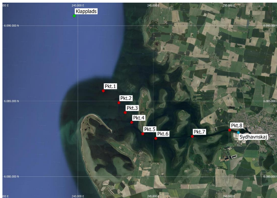
Figur 2.2: Spildkilder for uddybning af sejlrenden (rød), Sydhavnskaj (blå) og klapplads (grøn). Pkt. 3 til 6 dækker over Etape 1 af sejlrenden og resterende punkter dækker over Etape 2. Sydhavnskajens spildkilde er placeret stationært i bassinet ud for midten af den nye fuldt etablerede kajstrækning, da dette vurderes at give anledning til de højeste koncentrationer.
