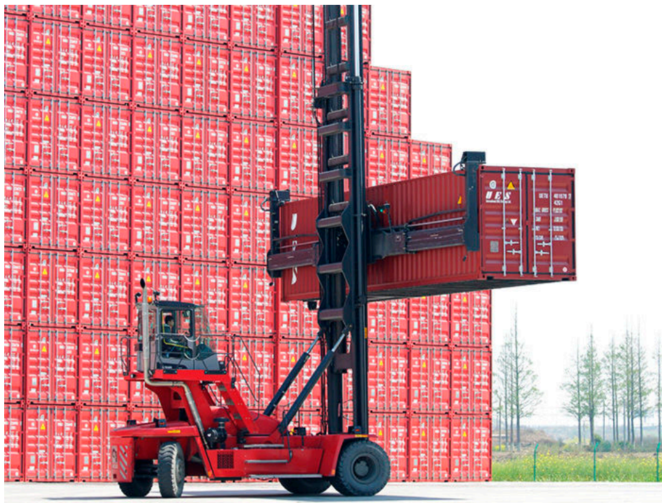
Figur 2.7: Eksempel på Empty Stackers, der anvendes til flytning og stakning af tomme containere.
