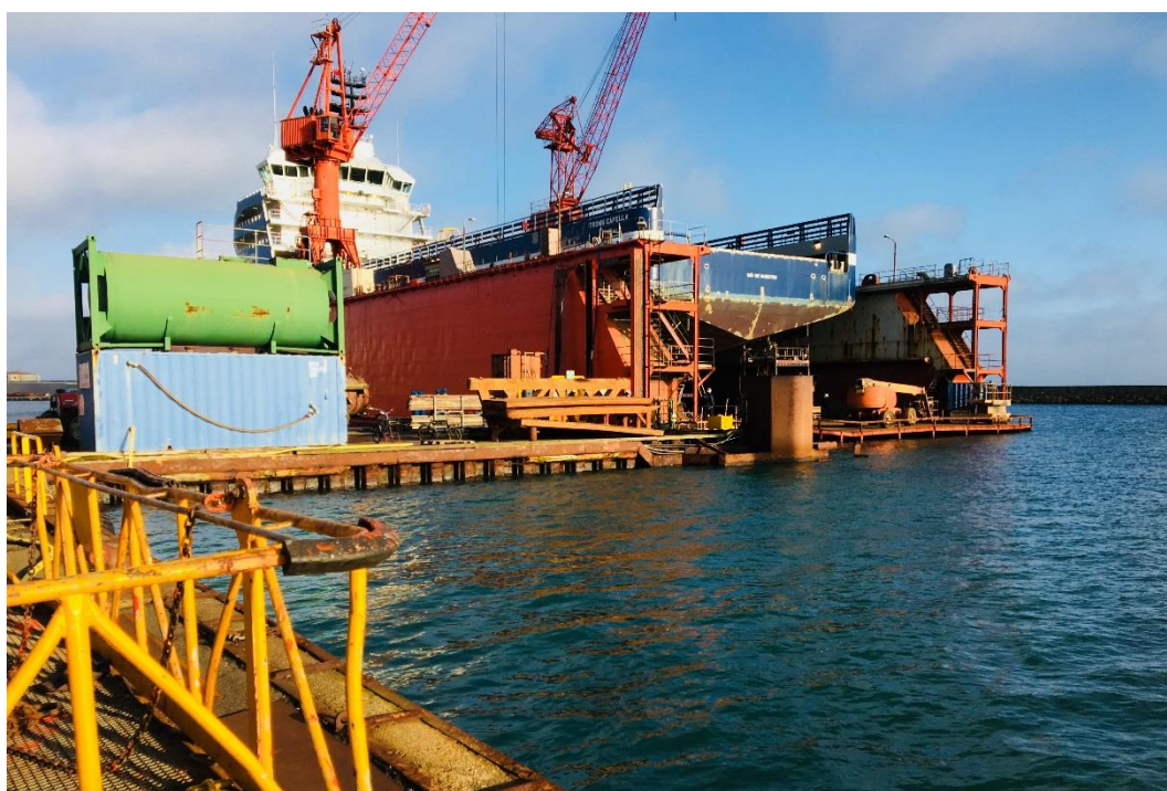
Figur 7-14. Eksisterende flydedok ved Orskov Værft med igangværende reparation af skib.
