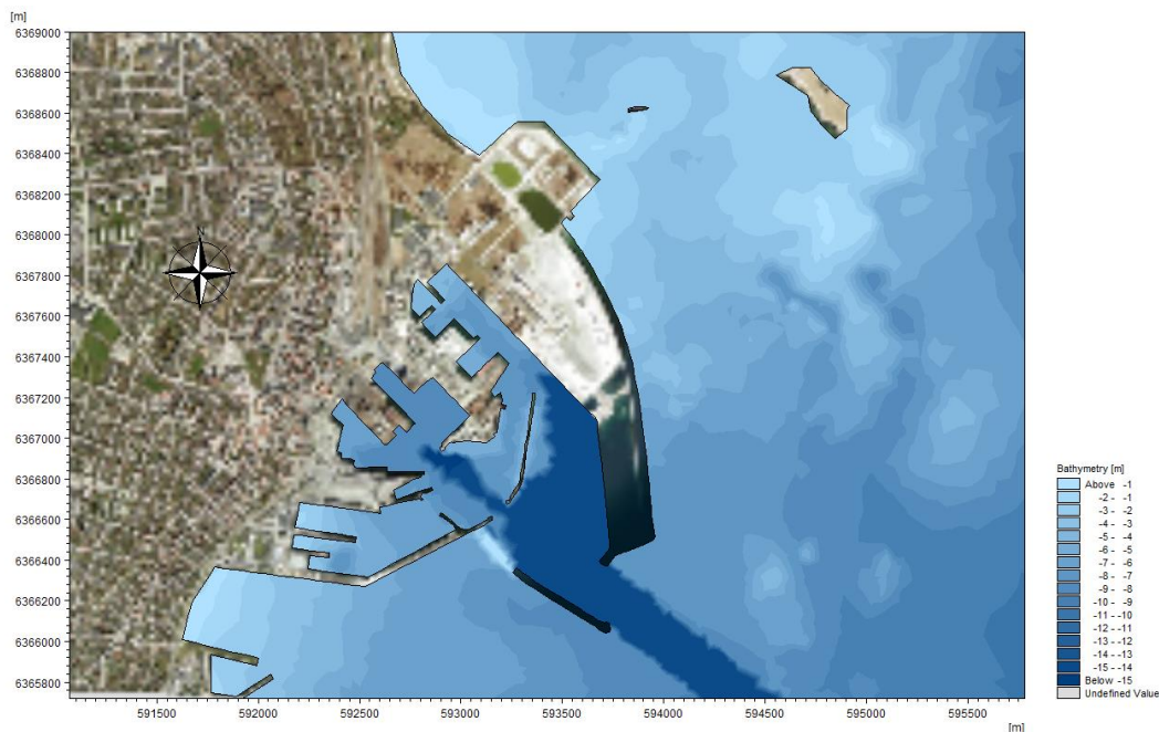
Figur 5-15. Zoom af modelområdet for eksisterende forhold (efter etablering af etape 2 for havneudvidelsen).
