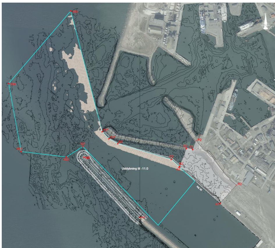
Figur 1 Kort over uddybningsområdet (markeret med turkis streg) beliggende uden for havnens dækkende værker i åbent farvand. På kortet ses Rønne Havns eksisterende landområder og dækmoler samt de øvrige påtænkte elementer i havneudvidelsen, dvs. forlængelse af dækmole (markeret med hvide linier) samt nyt landområde (grå markering NØ for uddybningsområde).
