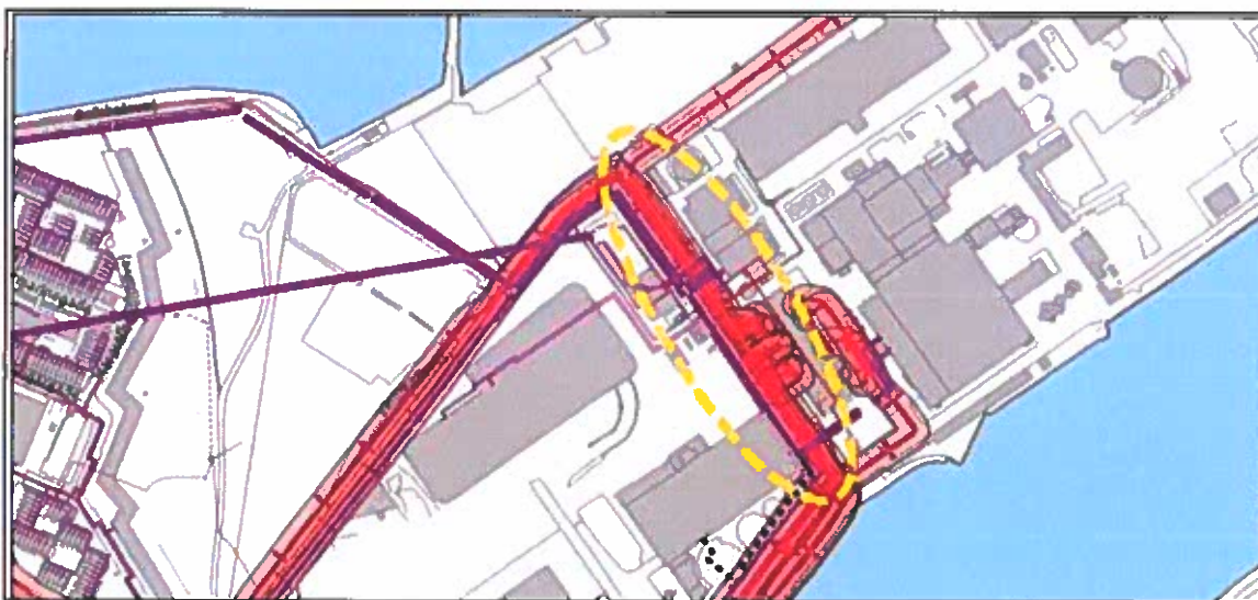
Figur 3 - Omtrentlig placering af højspændingskabler (Energinet).
