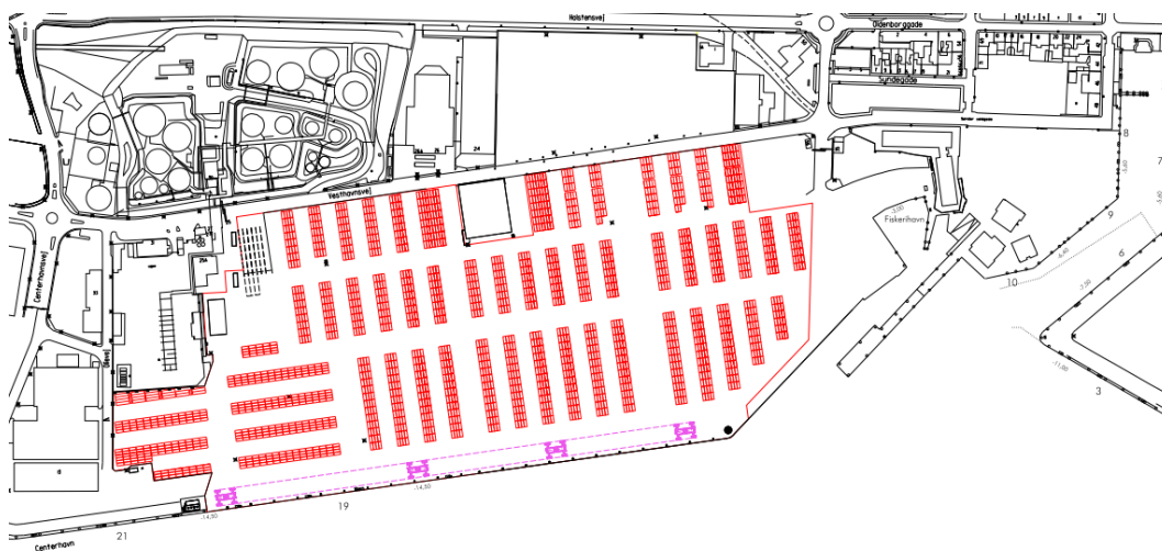
Figur 6 Forlængelse af kaj 19 og etablering af containerplads på de bagvedliggende arealer. Der opstilles to kraner på den forlængede kaj. Størvæg mod Fredericia indtegnet med rød streg langs den østlige afgrænsning af projektet.
